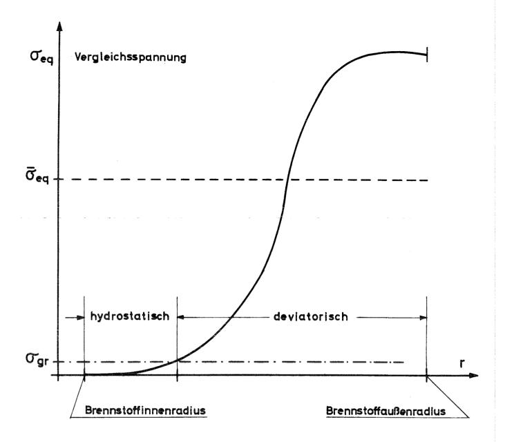
Abb. 5: Schematische Darstellung zur Behandlung des Brennstoffes nach dem Zweizonen - Modell (vgl. Abschn. 6.4.1)
