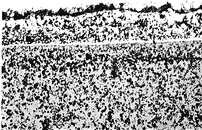
1.4988+(U 0.8 Pu 0.2 )O 1.98 650-700°C Abbr. 49 462 MWd/t 50µm 93% U-235 im Uran ; En > 0.1 MeV Abb.: 262
