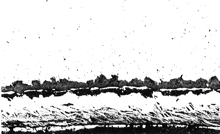
1.4988+UO 2.08 +CsJ+Cs+Se+Te 800°C/1000h sim.Abbr. 10 At.% 40µm ── Abb.: 252
