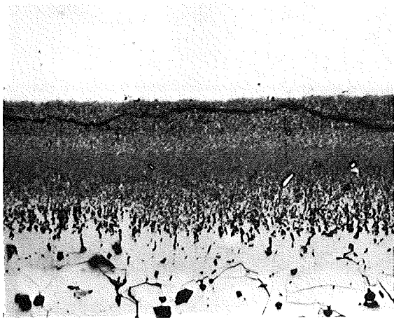
1.4988+Te 500°C/1000h Abb.: 119 20µm
