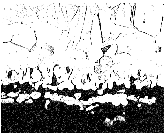
1.4970+J 700°C/1000h Abb.: 77 geätzt 20µm
