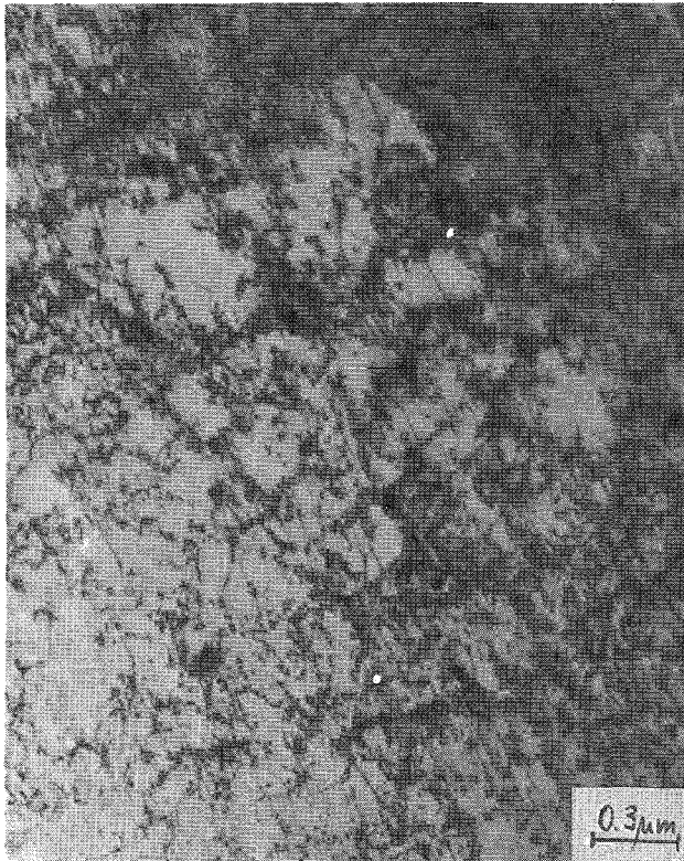
Abb. 3 Werkstoff Nr. 1.4970 unbestrahlt
