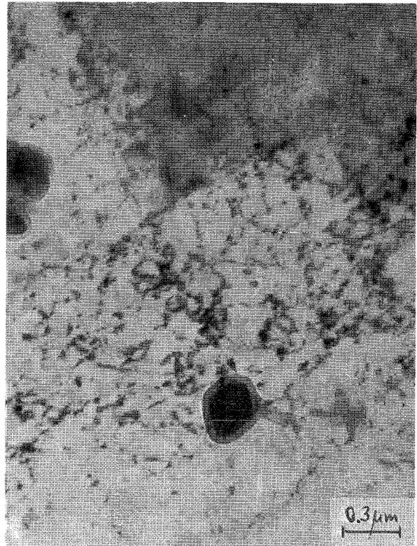
Abb. 4 Werkstoff Nr. 1.4970 bestrahlt
