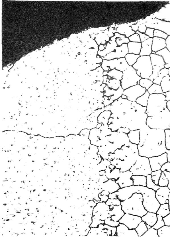
Abb. 17: Schlibfbild der Schweissnaht am Endstopfen des Stabes Nr. 39 (500-fach). Deutlich sichtbare Gefügeinhomogenitäten in der Verschweissungszone von Hüllrohr und Stopfen. Anzeichen für Reaktionen der Inhomogenitäten mit dem Natrium.
