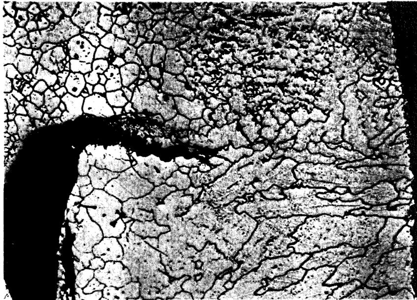
Abb. 16: Schliffbild (längs) nahe der Schadensstelle an der Verschweissung des Endstopfens von Stab Nr. 41 mit dem senkrecht zur Schweisszone entstandenen Riss (200-fach)
