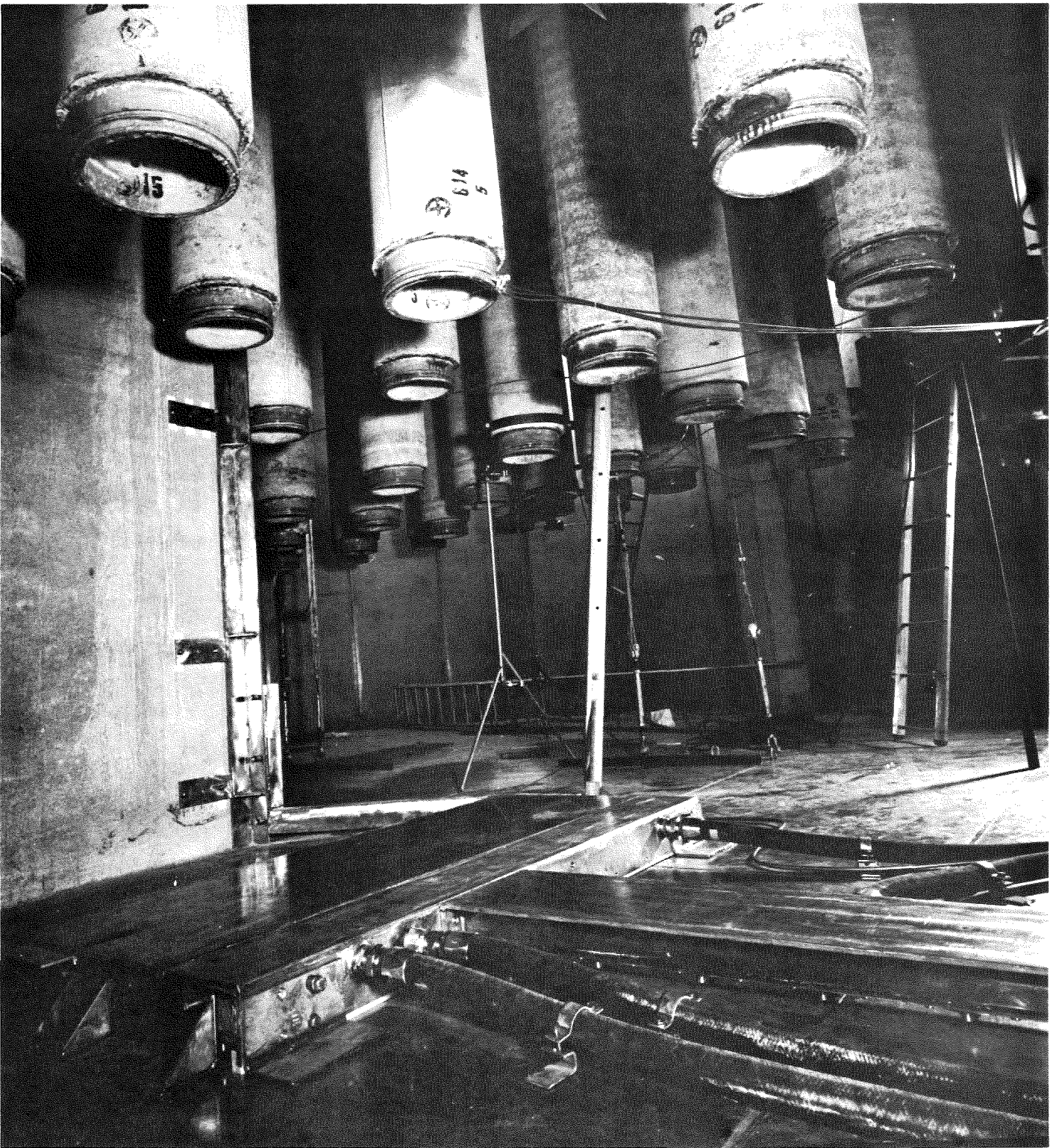
Abb. 7 Anordnung des Versuchseinsatzes in der Kondensationskammer
