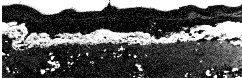
VTi 3 Sil+UO 2.08 +Te+Se+Cs+CsI+Mo+Ru (20 At % Abbr.) Abb.: 51 ─── 40 μm 800°C/1000h
