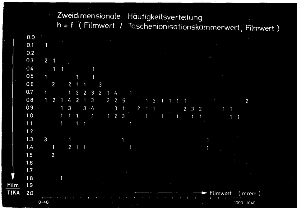
Abb.3: Ausdruck für Verteilung der Energieabhängigkeit der Verhältnisse der Ablesungen von Film- und Ionisationskammerdosimetern im Atomkraftwerk Beznau.
