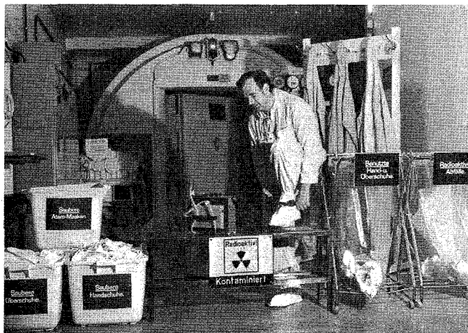
Abb. 1: Aufbau einer Kontaminationsschleuse
