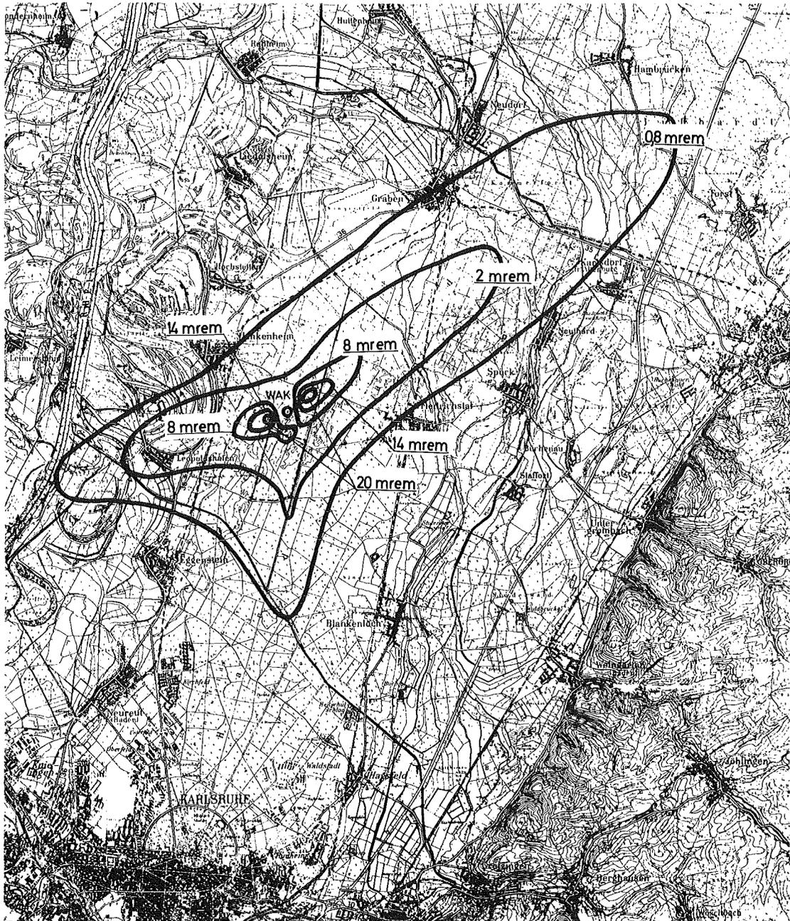
Abb. 72 Isolinien der  $\beta$ -Dosen durch  $Kr-85$  -Emission der WAK
