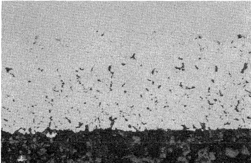
Abb. 6 20 \mu\text{m} \longleftarrow 1.4970+UO 2+x +Spaltprodukte 800°C/1000 h
