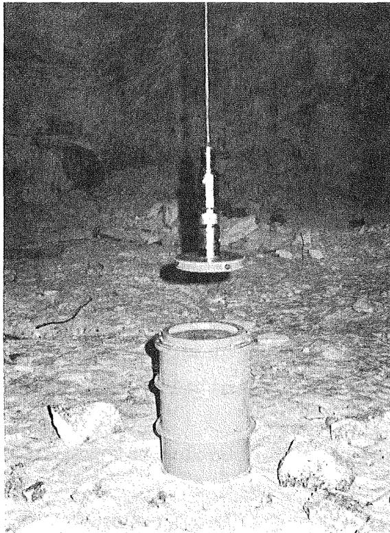
Abb. 25 Lagerkammer für mittelaktive Abfälle auf der 511 m-Sohle: Rollreifenfaß nach Ausklinken der Faßreifervorrichtung
