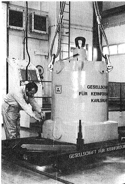
Abb. 27 Einzelabschirmbehälter E 1 mit Rollenbock
