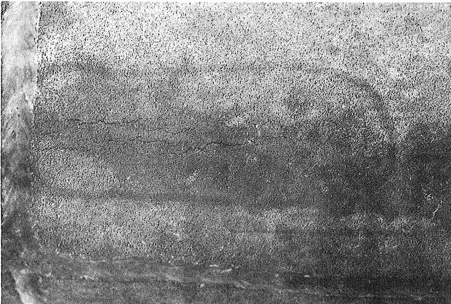
Abb. 19 Risse an der Oberfläche der Kerzenfilterwand nach ca. 800 Betriebsstunden
