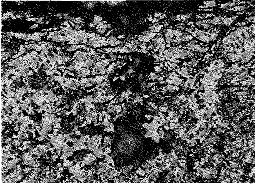
Abb. 6 : \text{UO}_2/\text{PuO}_2 -Tablette als Preßling ausgebohrt, als Sinterling geschliffen
