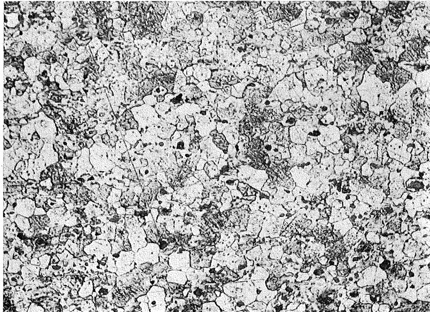
Abb. 9d Struktur im Druckkegel der in Abb. 9a dargestellten Probe Korngröße 134 \mu\text{m}^2
