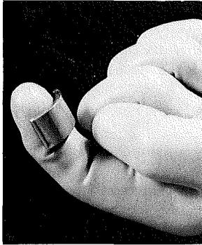
Fig. 7: Neutronen-Fingerdosimeter
