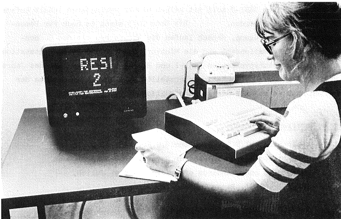
Abb. 4510-2: Datensichtstation für die Datenfernverarbeitung in RESI-2 über normale Telefonverbindungen
