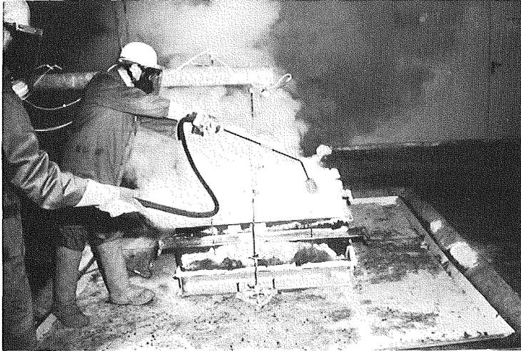
Abb. 25 Abdecken eines Flächenbrandes  $1,1 \text{ m}^2$  mit Löschpulver
