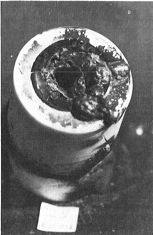
Abb. 4243.1: Schmelzanlage SASCHA für Schmelzversuche mit schwach aktiven Corium-Proben in oxidierender Atmosphäre
