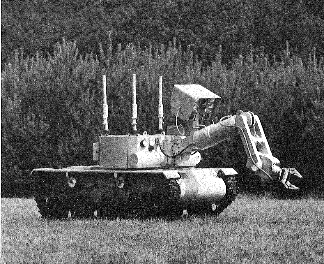
Bild 4422-1: Mittleres Manipulator-Fahrzeug "MF2" mit schwerem Kraft-Manipulator "SM5-D" und Fernsehkameras, funkgesteuert; in Arbeitsstellung
