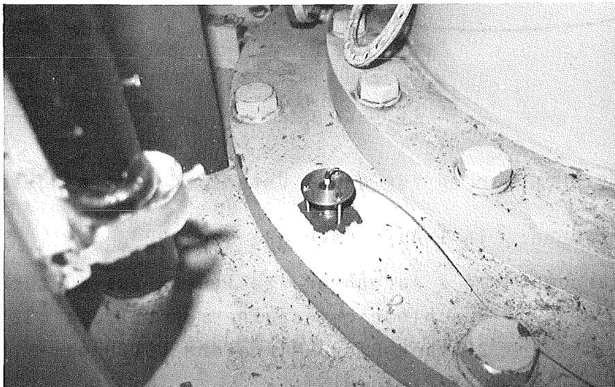
Bild 3: Piezo-Schallaufnehmer am oberen Stützflansch der Sekundärpumpe QS1. Mit Hilfe des Schalldruckaufnehmers wurde das akustische Pumpenspektrum mit einer Bandbreite von 140 kHz und mit einem Dynamikumfang von 56 db aufgezeichnet.
