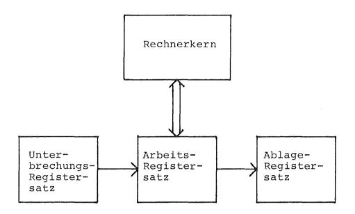
Bild 1. Unterbrechungs-Bearbeitung
