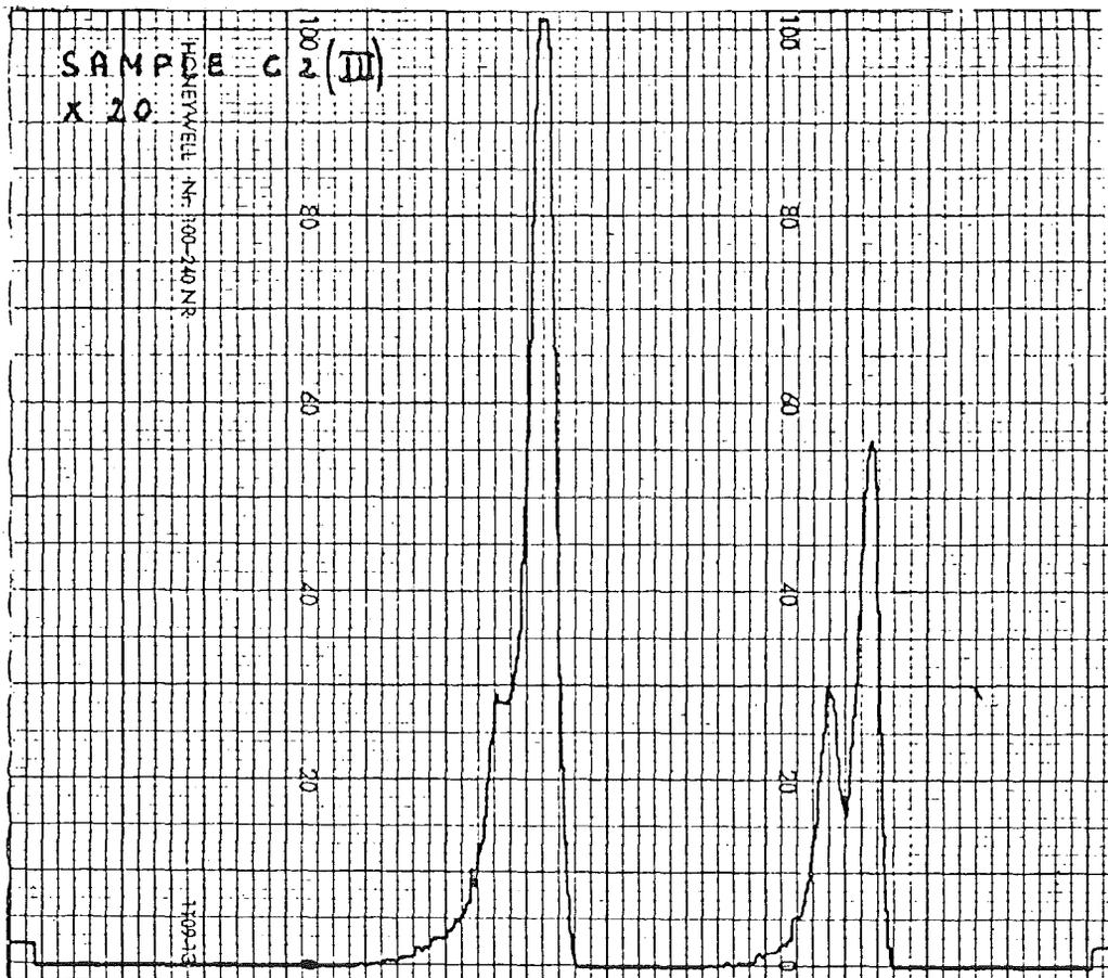
Abb. 2: Plutonium-Spektrum hoher Auflösung (0.2 % Pu-238; Elektrodeposition)
