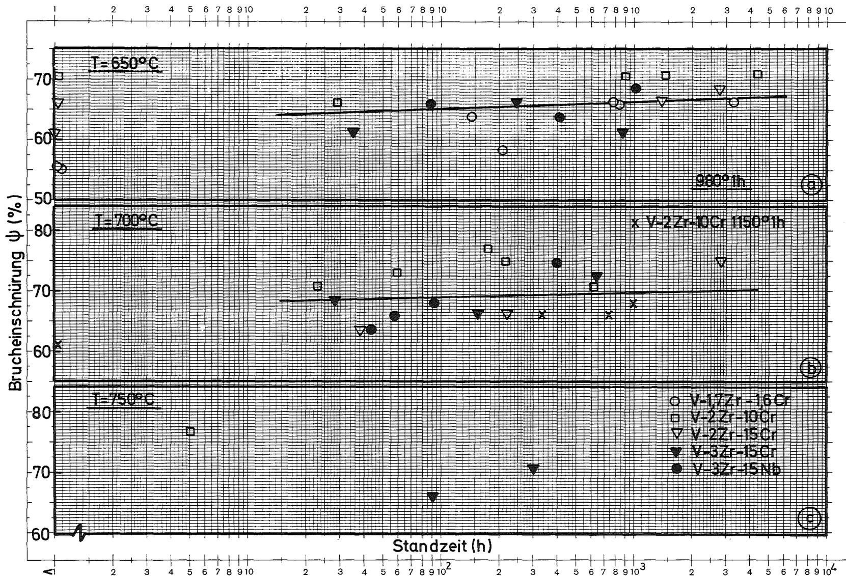
Bild 15a-c: Bruchdehnung in Abhängigkeit von der Standzeit
