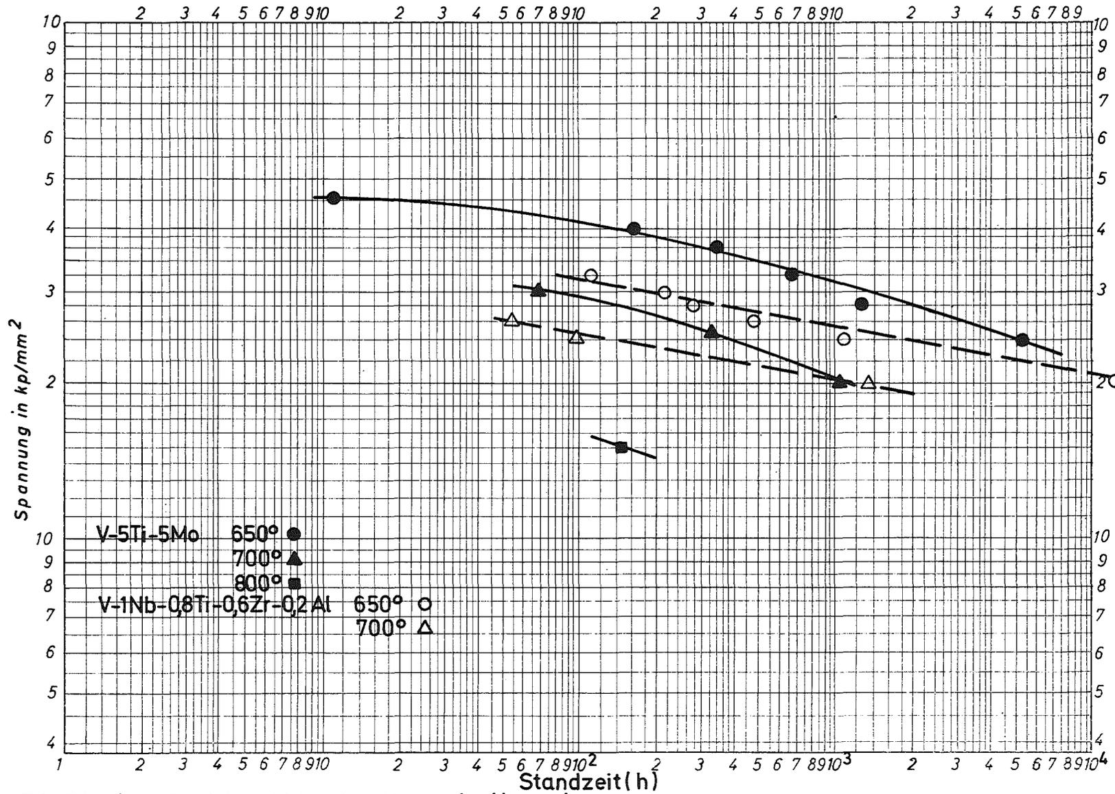
Bild 52: Standzeit in Abhängigkeit von der Versuchsspannung
