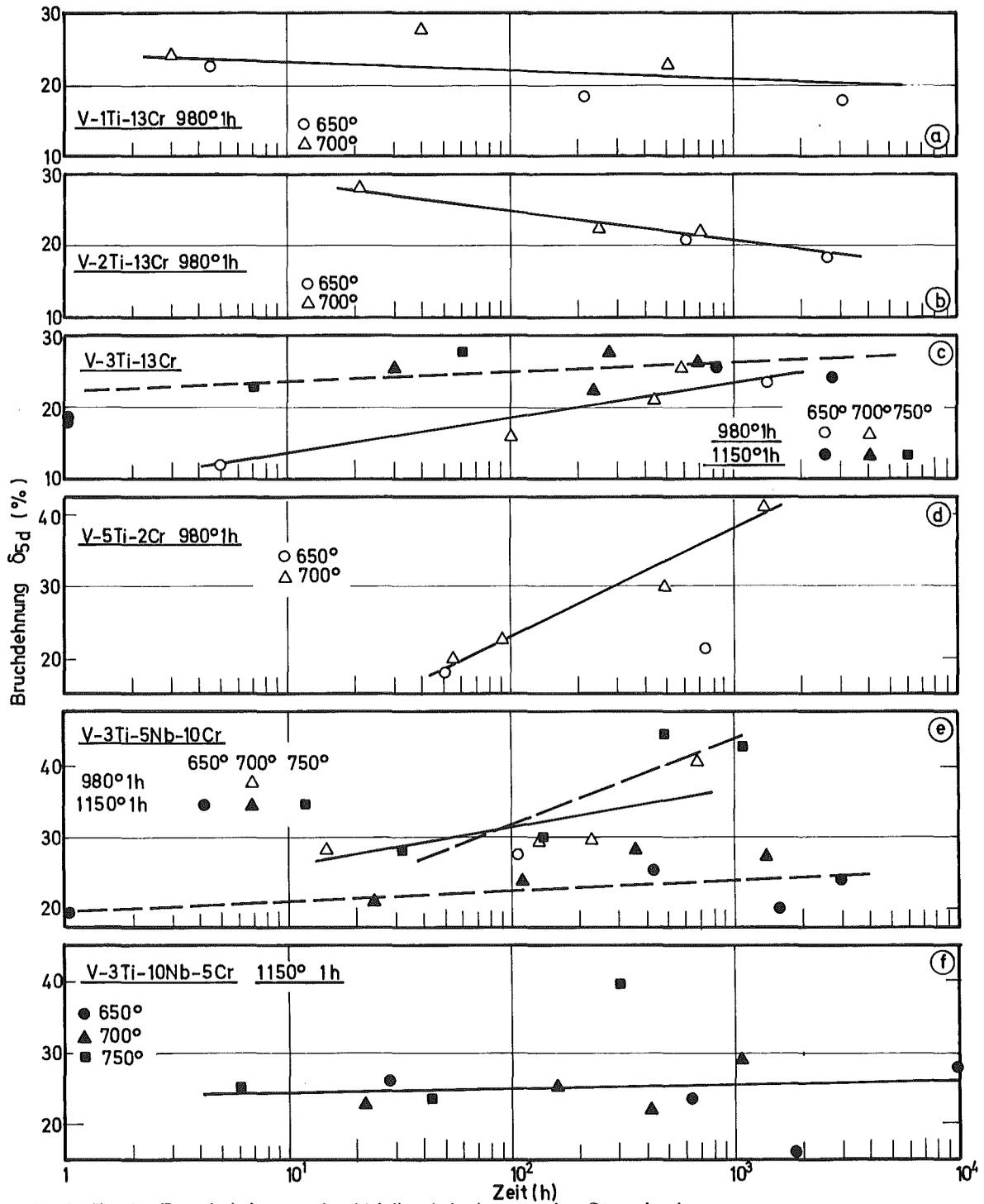
Bild 27a-f: Bruchdehnung in Abhängigkeit von der Standzeit
