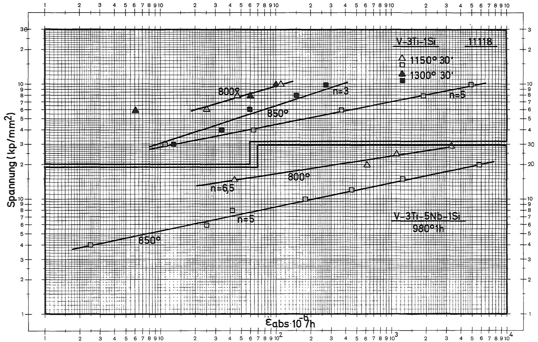
Bild 42: Sekundäre Kriechgeschwindigkeit in Abhängigkeit von der Spannung
