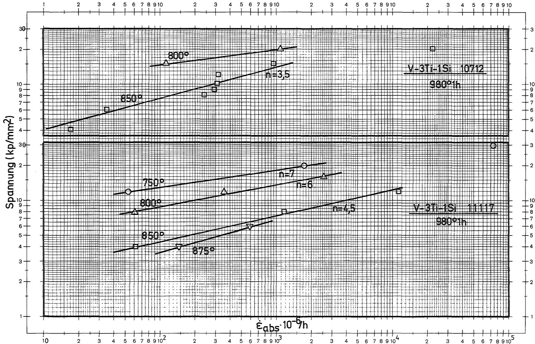
Bild 40: Sekundäre Kriechgeschwindigkeit in Abhängigkeit von der Versuchsspannung
