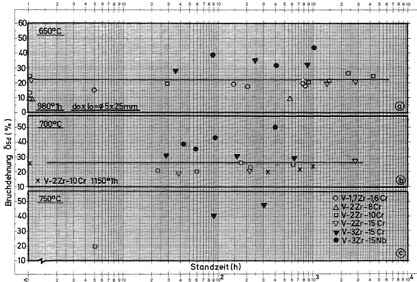
Bild 14 a-c: Bruchdehnung in Abhängigkeit von der Standzeit
