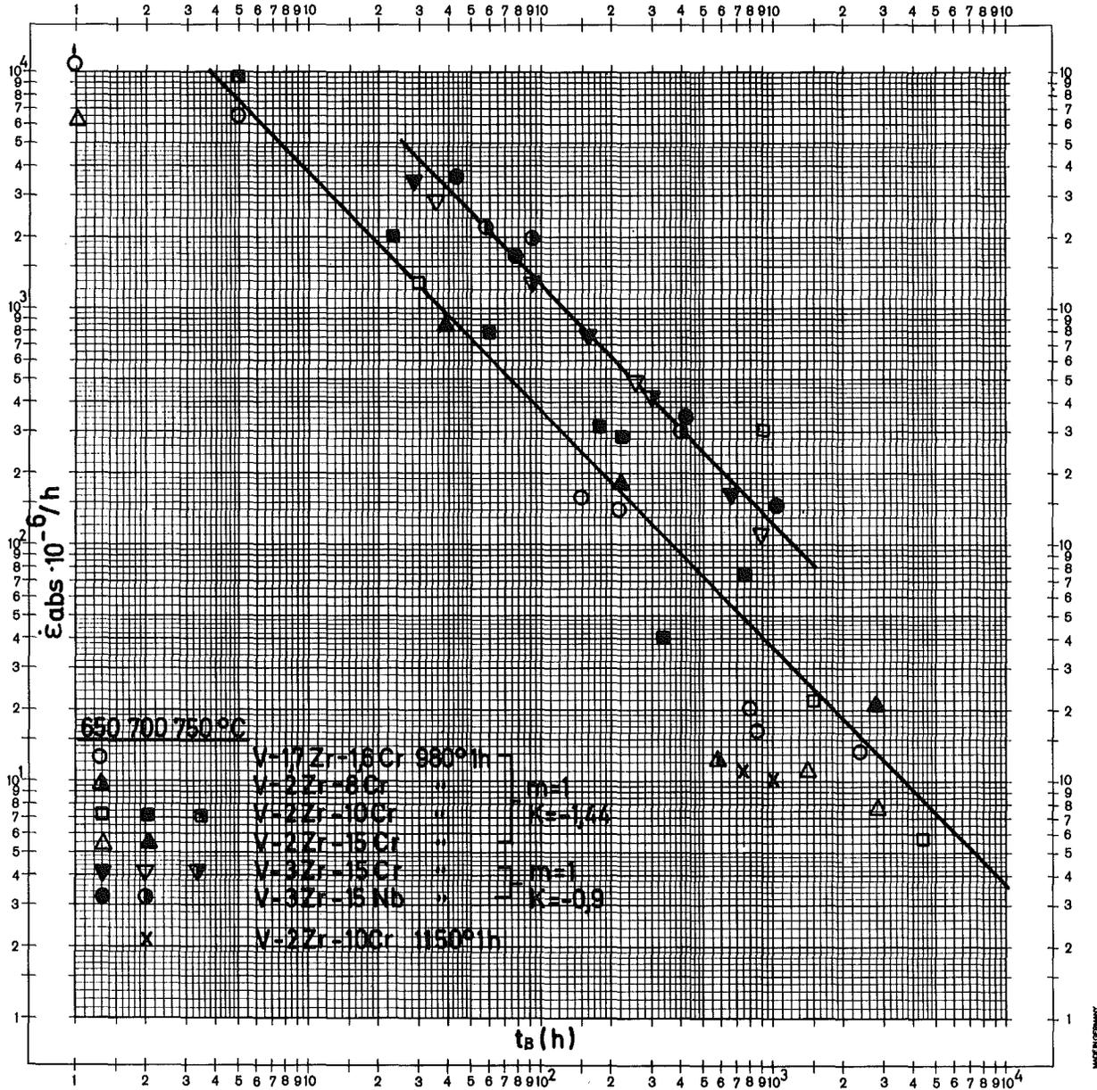
Bild 13: Standzeit in Abhängigkeit von der sekundären Kriechgeschwindigkeit
