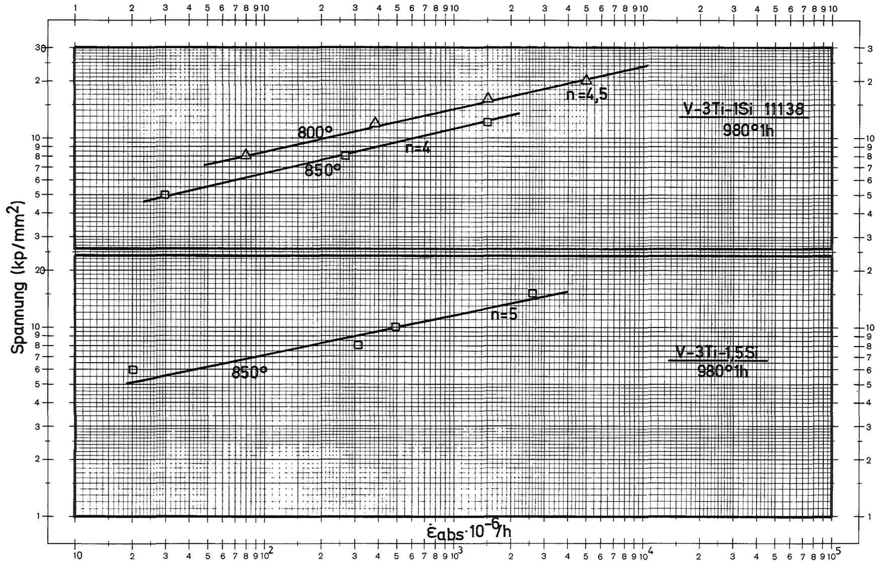
Bild 41: Sekundäre Kriechgeschwindigkeit in Abhängigkeit von der Spannung
