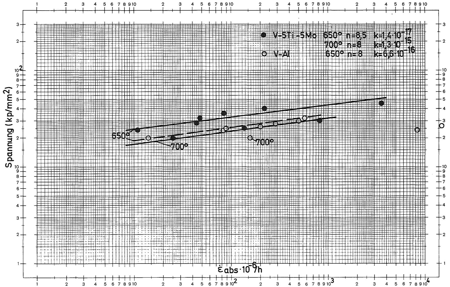
Bild 53: Sekundäre Kriechgeschwindigkeit in Abhängigkeit von der Versuchsspannung
