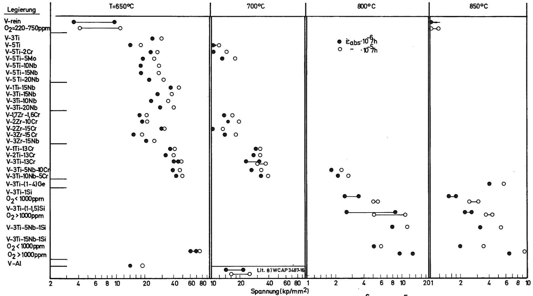
Bild 69: Versuchsspannungen, die zu einer sekundären Kriechgeschwindigkeit von  $\epsilon_{abs} \cdot 10^{-6}$  bzw.  $10^{-5}$  führen, für V-rein und verschiedene Vanadin-Basis-Legierungen
