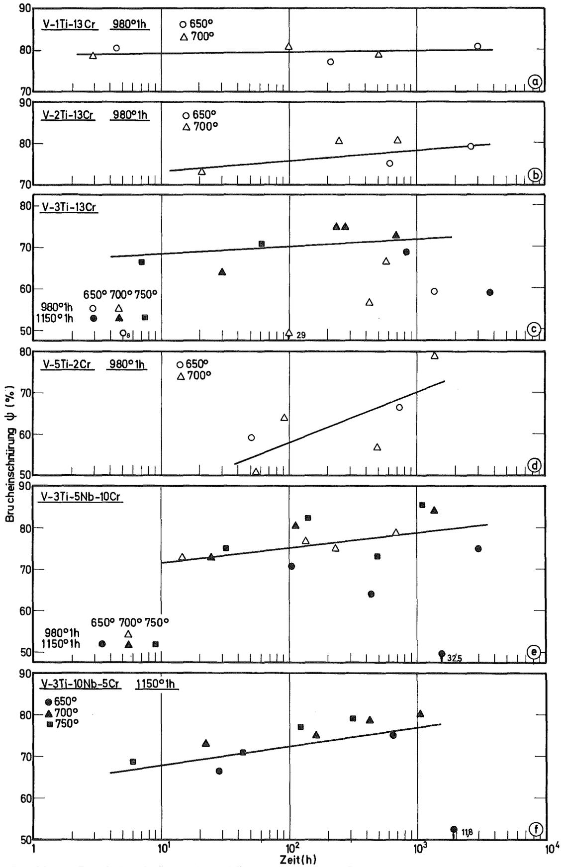
Bild28 a-f: Bruchdehnung in Abhängigkeit von der Standzeit
