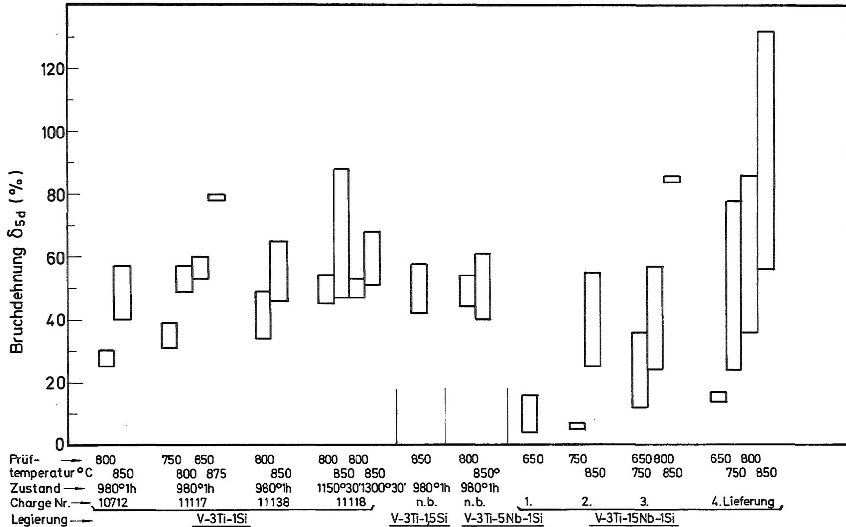
Bild 44: Duktilitätsbereiche von V-Ti-Si- und V-Ti-Nb-Si-Legierungen
