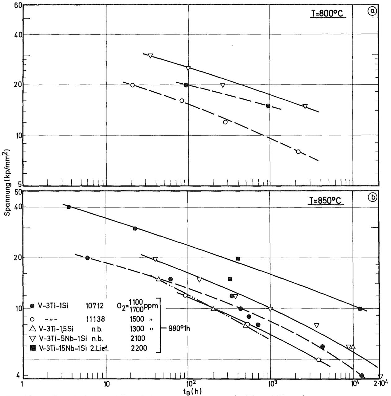
Bild 37a,b: Standzeit in Abhängigkeit von der Spannung (bei O<sub>2</sub> >1000ppm)
