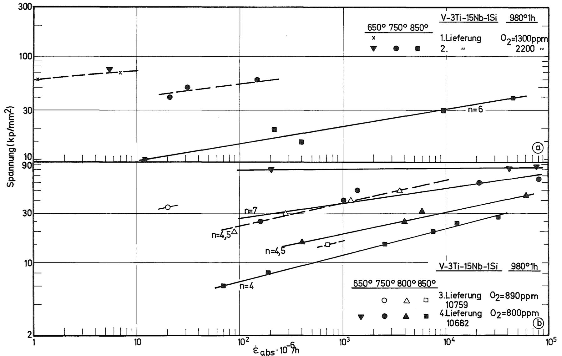
Bild 43: Sekundäre Kriechgeschwindigkeit in Abhängigkeit von der Spannung
