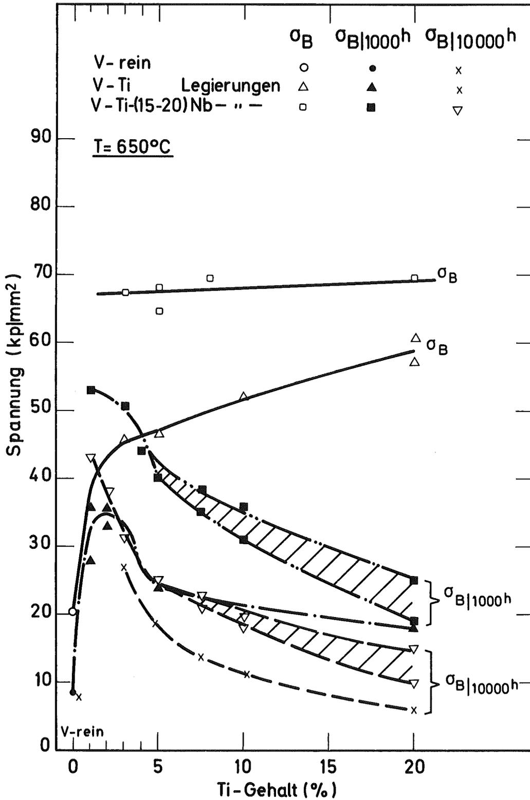
Bild 68: Tendenz der Zugfestigkeit u. der Langzeitfestigkeit von V-rein, V-Ti- u. V-Ti-Nb-Legierungen in Abhängigkeit vom Ti-Gehalt.
