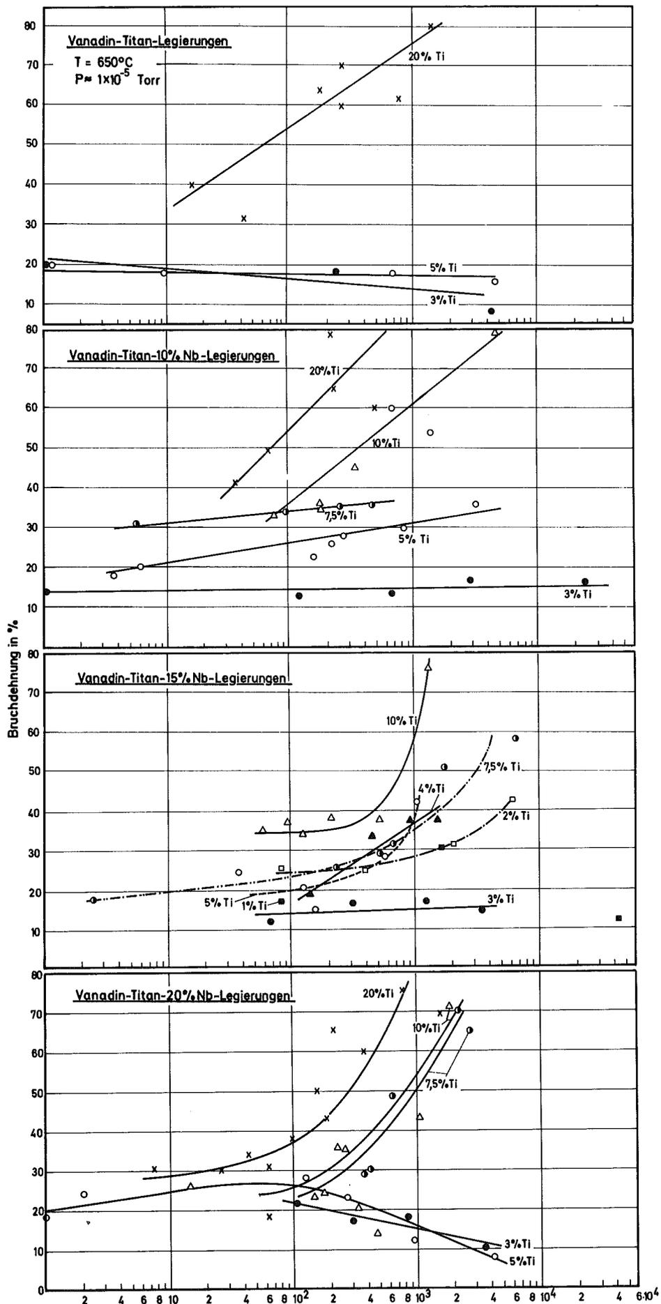
Bild 3: Bruchdehnung in Abhängigkeit von der Standzeit bei verschiedenen Ti-Gehalten
