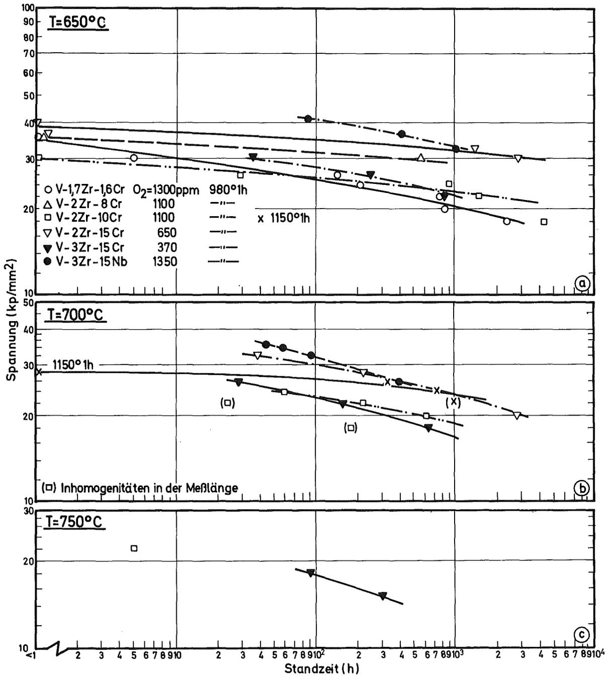
Bild 11a-c: Standzeit in Abhängigkeit von der Versuchsspannung
