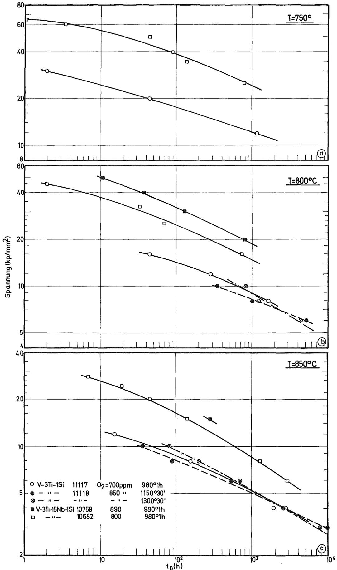
Bild 36a-c: Standzeit in Abhängigkeit von der Spannung (bei  $O_2 < 1000\text{ppm}$ )
