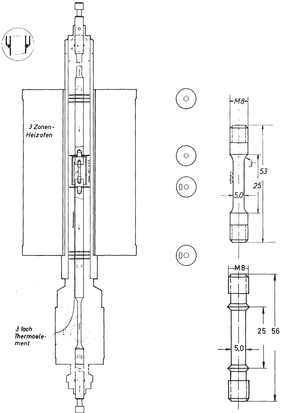
Probenform und Teststrecke für Vakuum-Zeitstandversuche
