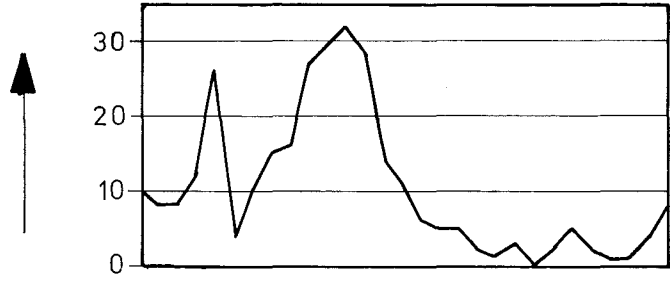
Axiale Verteilung der Ovalität im Hüllrohr
