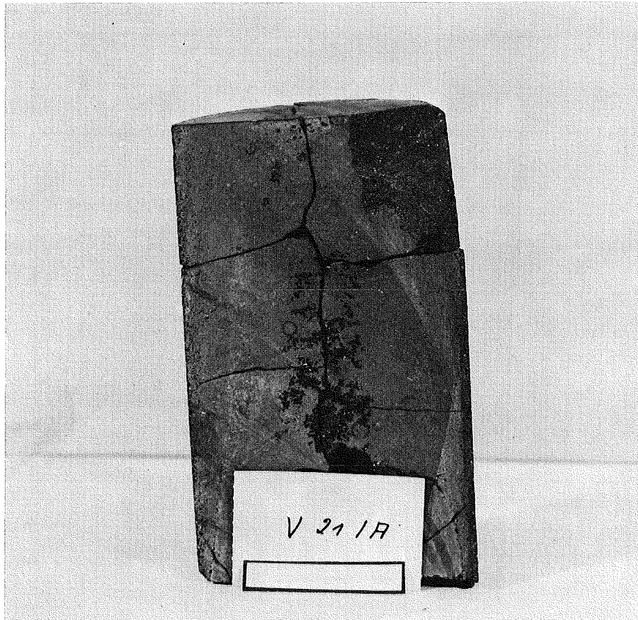
Abb. 8: Längsschnitt durch ein Reaktions- produkt (Mischung D, Tiegel II)
