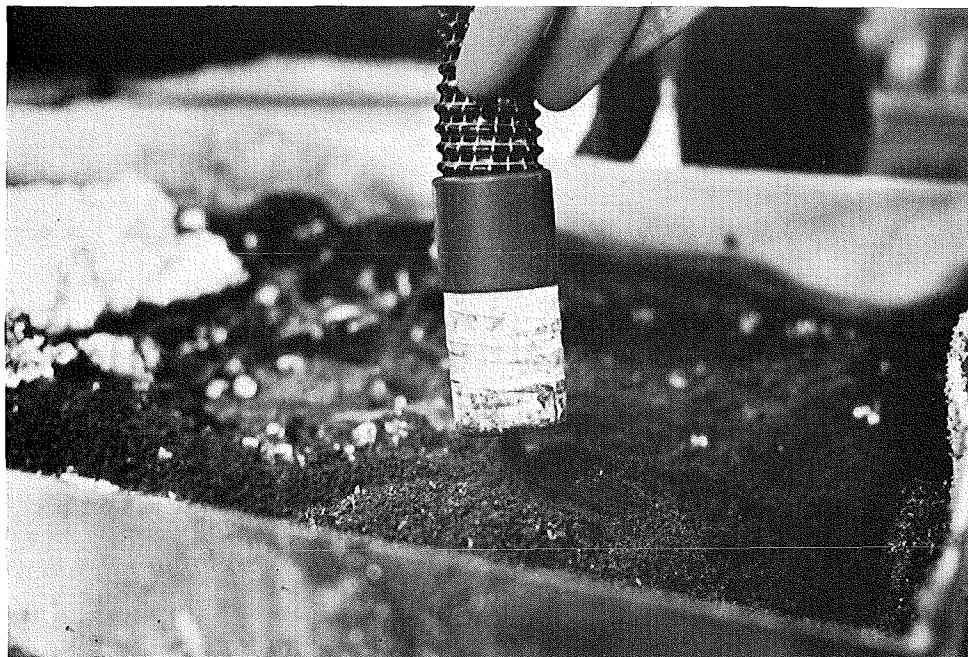
Abb. 9: Absaugen des Löschpulvers nach Erkalten des Natriums.
