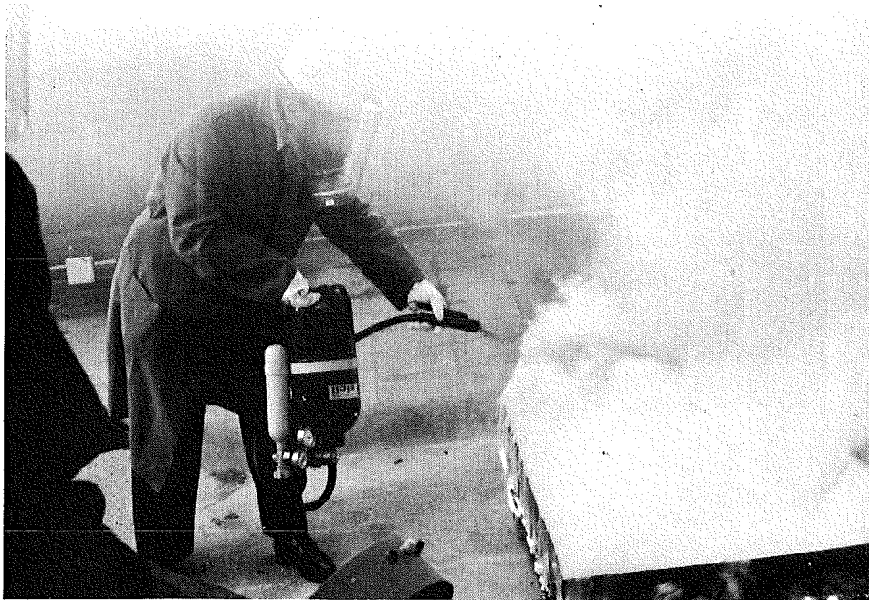
Abb. 5: Beginn Löschaktion mit Handfeuerlöscher mit Graphitlöschpulver. Natrium brennt auf der ganzen Fläche.
