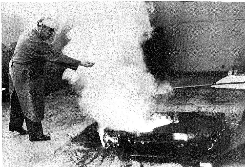
Abb. 7: Brandwanne mit an einer Stelle entferntem Löschpulver. Aufgabe von pelletiertem Löschpulver mit der Hand.
