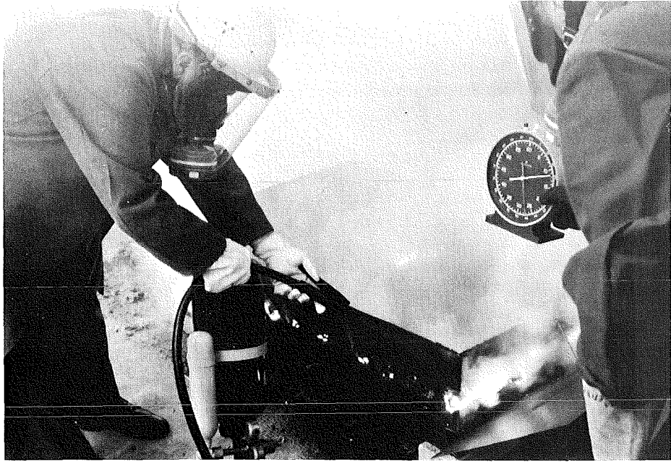
Abb. 6: Ende des Löschvorganges. Der Blähvorgang des sich erwärmenden Löschpulvers läuft weiter. Beginn Löschversuche des am Rande ausgetretenen Natriums.
