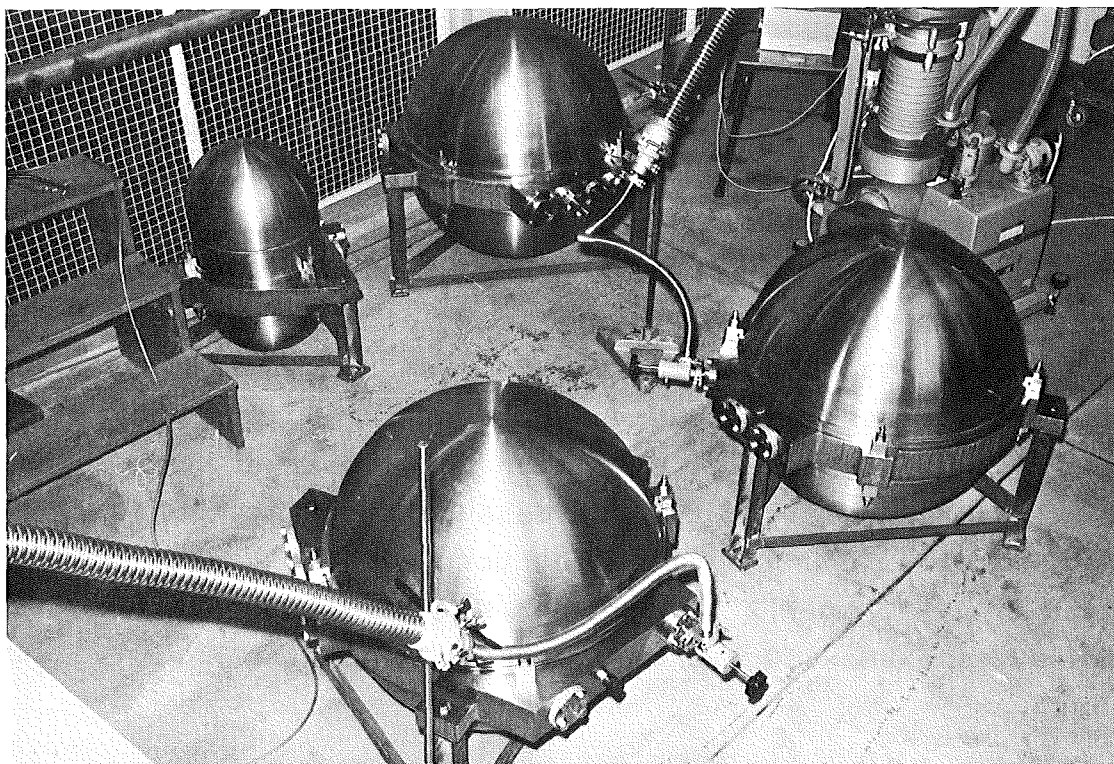
Abb. 2.9 Die vier großen Druckbehälter (beim ersten Helium-Lecktest)
