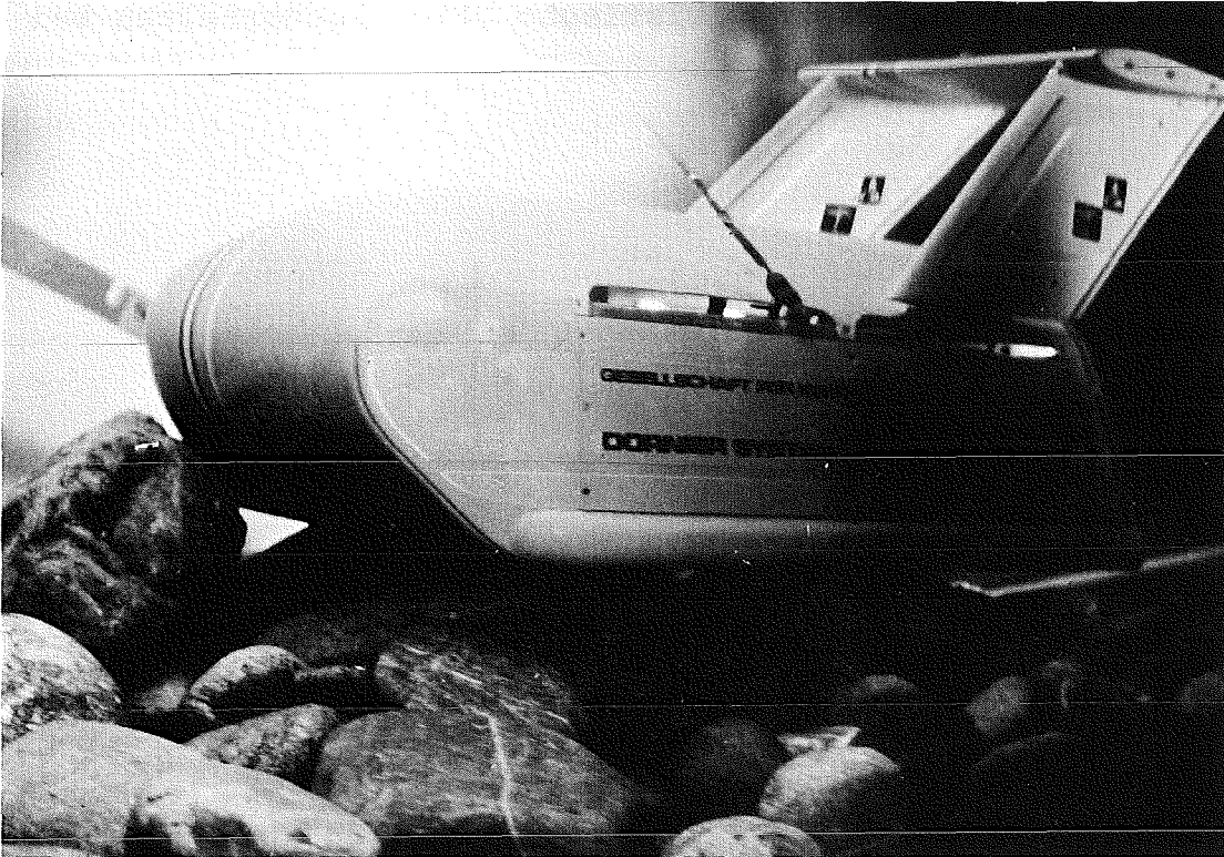
Abb. 2.5 MANKA-Modell im Wasserkanal beim Überwinden von Hindernissen
