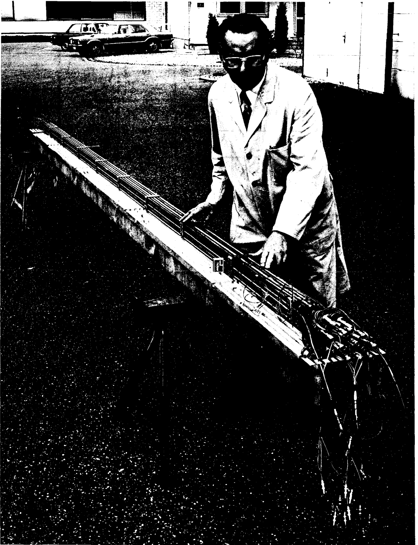
Abb. 15: Stabbündel vor Einbau in Kasten
