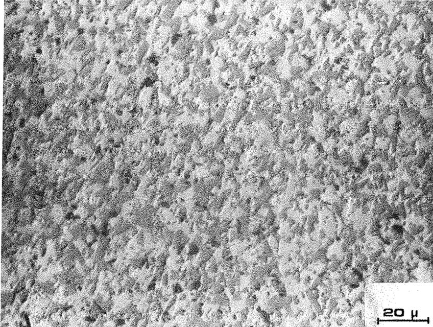
Abb.4: Gefüge der gesinterten 25 TaC/75 TaN+10 Ni Probe
