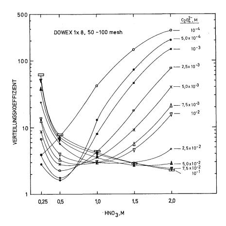
Abbildung 6: Abhängigkeit des Verteilungskoeffizienten von Pu $^{4+}$  von der Salpetersäurekonzentration im System 0,25-2,0 M HNO $_3$ /10 $^{-4}$ -10 $^{-1}$  M (NH $_4$ ) $_2$ C $_2$ O $_4$ /100 mg Dowex 1-X8, 50-100 mesh, NO $_3$ -Form siehe Kap. 6 Tab. 3
