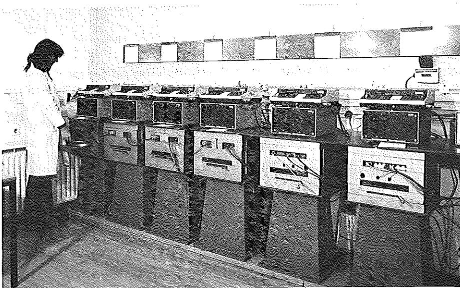
Abb. 5/3: Kleinrechnergesteuerte  $\alpha$ - $\beta$ -Bruttoaktivitätsmeßplätze
