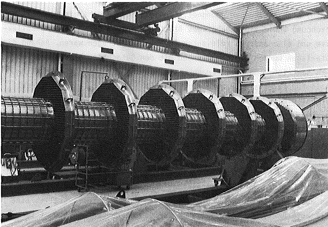
Abb. VIII-5: Zwischenwärmetauscher - Zentralrohr mit Rohrhalterungsplatten
