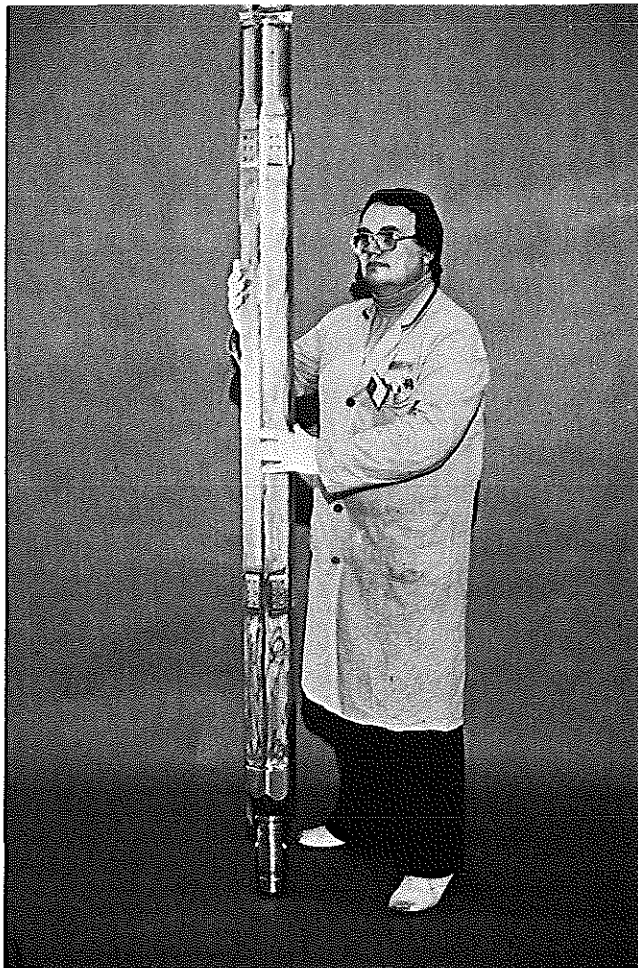
Abb. V-4: Brennelement für KNK II
