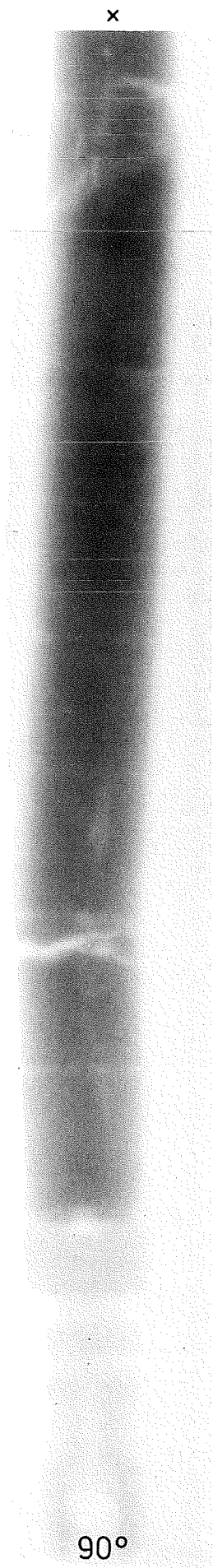
90° Betatron-Durchleuchtung von Stab 6D1
