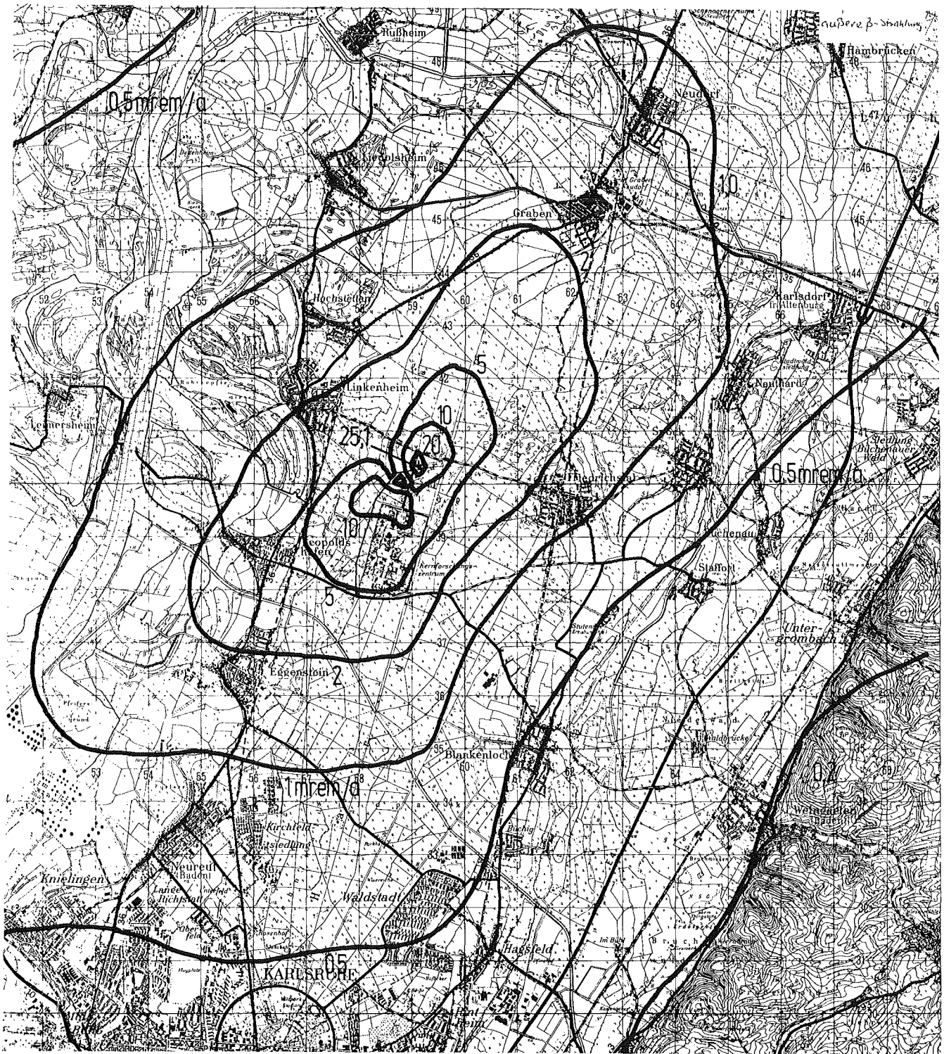
Abb. 7/16: Hautdosis durch externe Betastrahlung, Prognose 1981 (1 mrem = 10 \mu Sv)
