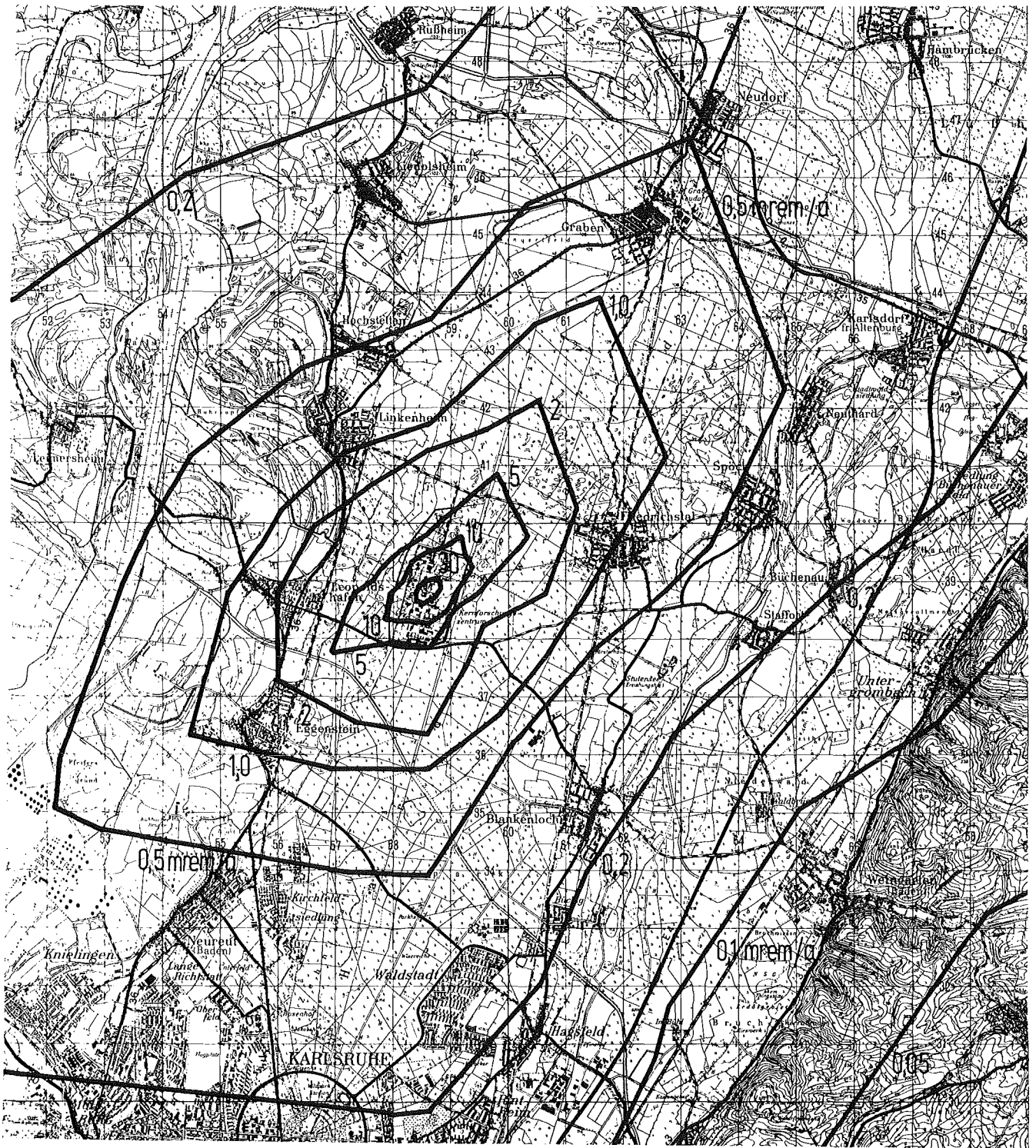
Abb. 7/15: Ganzkörperdosis durch äußere Gammastrahlung, Prognose 1981 (1 mrem = 10 \mu Sv)
