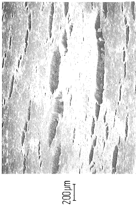
Abb. 06.01.06/13A-6: Zircaloy-4-Hüllrohrinnenoberfläche und Bruchfläche nach dem Versagen infolge Spannungsrißkorrosion durch Jod
