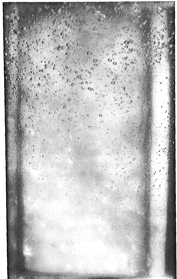
Bild 3: Strömungsvorgänge am senkrechten Betonsimulator im Wasserbad von 15 °C.
