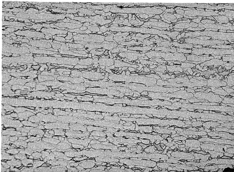
Abb.12 Querschliff des Cr-Ni-Stahls 1.4462 nach der Wärmebehandlung (Phasen- neubildung) (V = 500:1, geätzt mit Nital)
