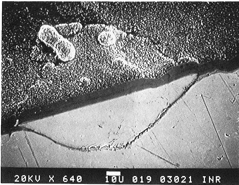
Abb. 6.14 Querschnitt und Oberfläche des Schichttyps 3 in der Umgebung einer Schuppe, 640-fach.
