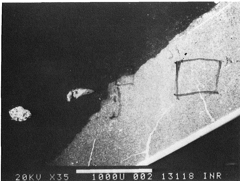
Abb. 4.12: Schliffbild der Grenzfläche zwischen dem HfC-Bruchstück (hellere Fläche) und der Stahlschmelze (dunkle Fläche oben). Die beiden hellen Zonen im Stahlbereich wurden als Gasblasen identifiziert (35 fach)
