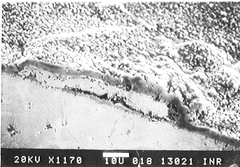
Abb. 6.3 Querschnitt durch Schichttyp 1 auf einer durch eine Schuppe gestörten Oberfläche. Struktur mit Poren und durchgängigen Rissen, REM, 1170-fach.
