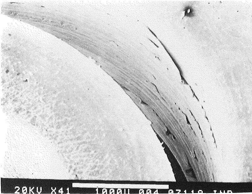
Abb. 5.15 Oberfläche von 2 Probestäben nach einer Biegung um 360°. Die TiN-Schicht (rechts) splitterte schuppenartig ab, während die TiN/TiC-Schicht (links) zwar Risse aufwies, jedoch noch auf dem Niobstab haftete, REM. 41 x.
