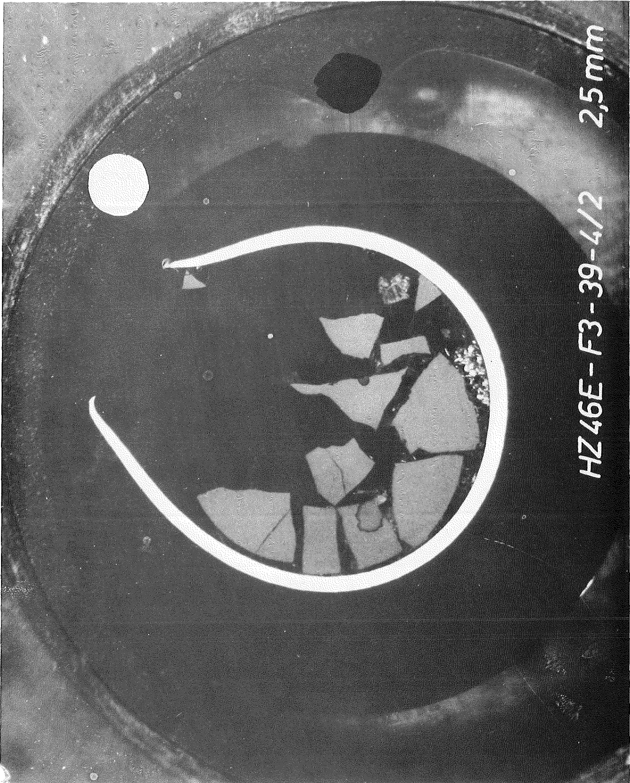
Abb. 2-3: Übersichtsaufnahme der Berststelle des Stabes F3
