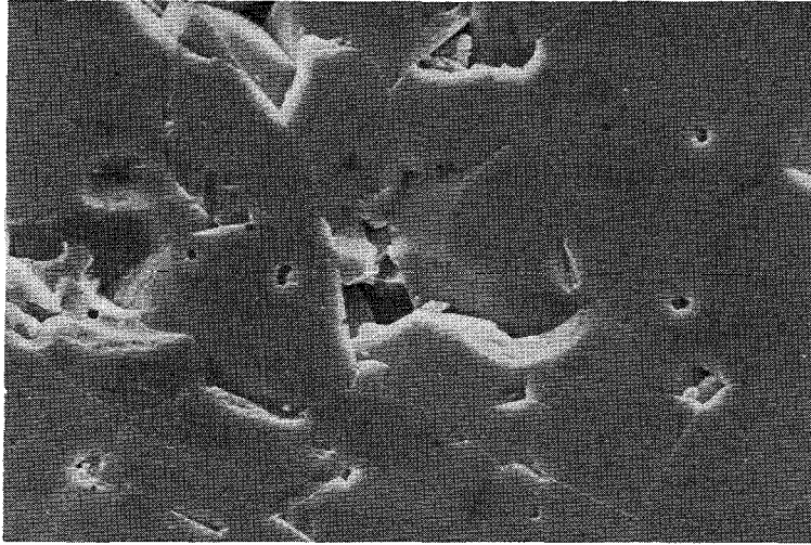
Bild 26 REM-Aufnahme von Al 2 O 3 (3) poliert vor der Auslagerung in Q-Lösung
