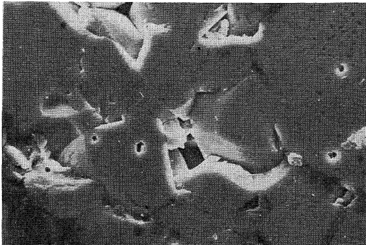
Bild 27 REM-Aufnahme von Al 2 O 3 (3) poliert nach der Auslagerung in Q-Lösung. (Korrosionsbedin- gungen: Druck 130 bar, Temperatur 200°C, Dauer 91 Tage) Befund: kein sichtbarer Korrosionsangriff der Oberfläche, jedoch geringfügige Ablagerungen vom Korrosionsmedium entlang der Korngrenzen
