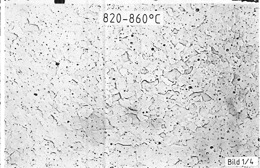
BSS 26, AZIMUT 170^{\circ} , (IN RICHTUNG RISS,) 5mm ÜBER RISSENDE
