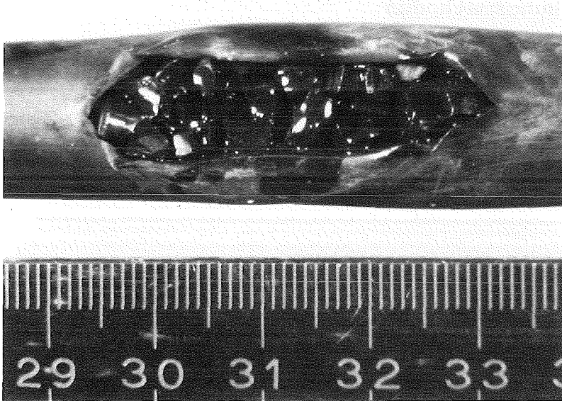
Abb. 5-3: Fragmentierung der UO 2 -Pellets und lose Ansammlung im Berstbereich des Prüflings G 3.2 (35 000 MWd/t U ).
