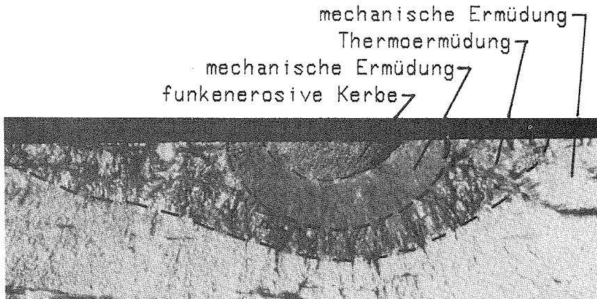
Abb. 6 Durch zyklische Thermoschockbelastung erzeugter Ermüdungsriß im 22NiMoCr37
