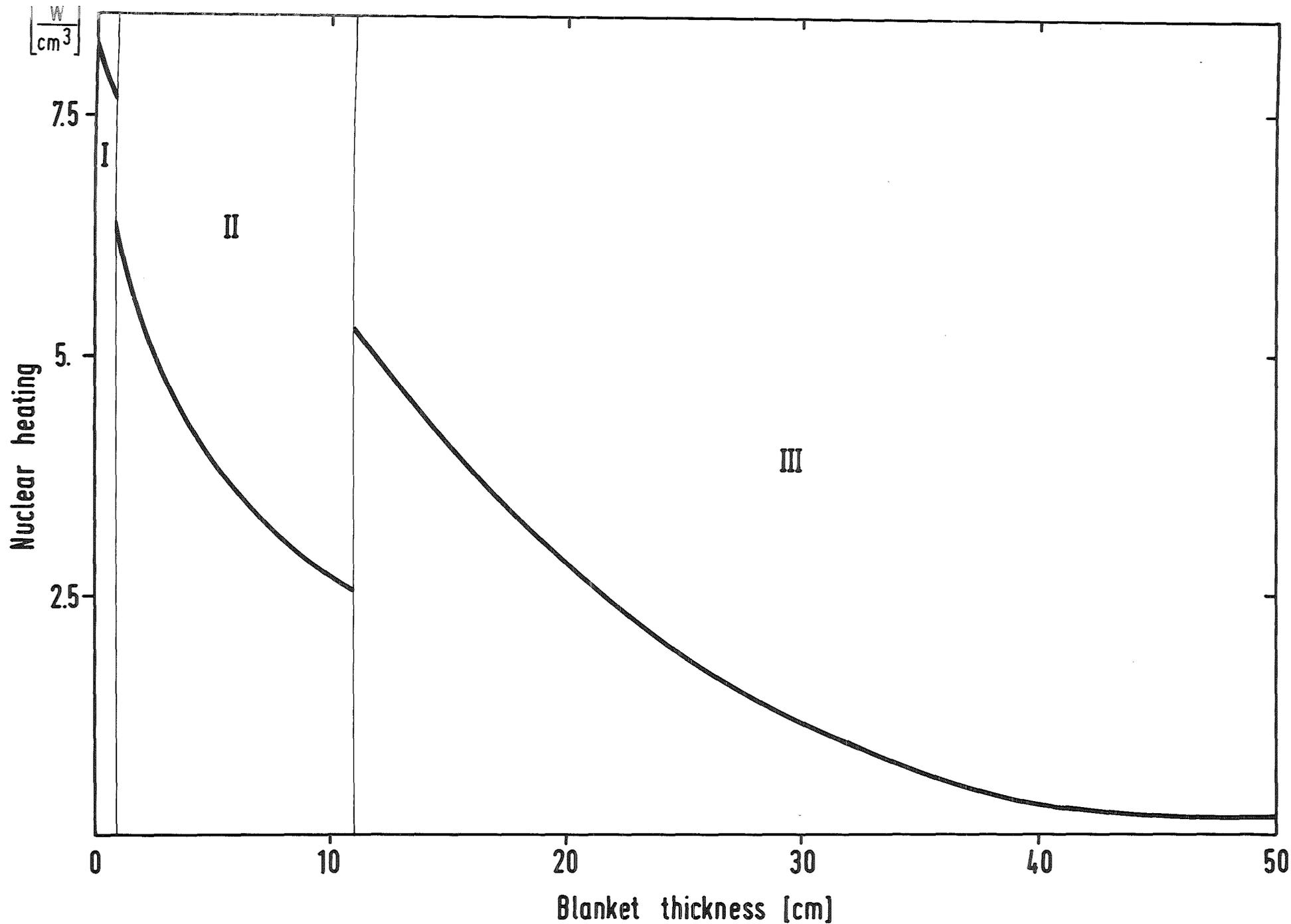
Fig. 3.10b two breeding zones, 4 % SS vol., 8 % void vol. sph. geom. point source
