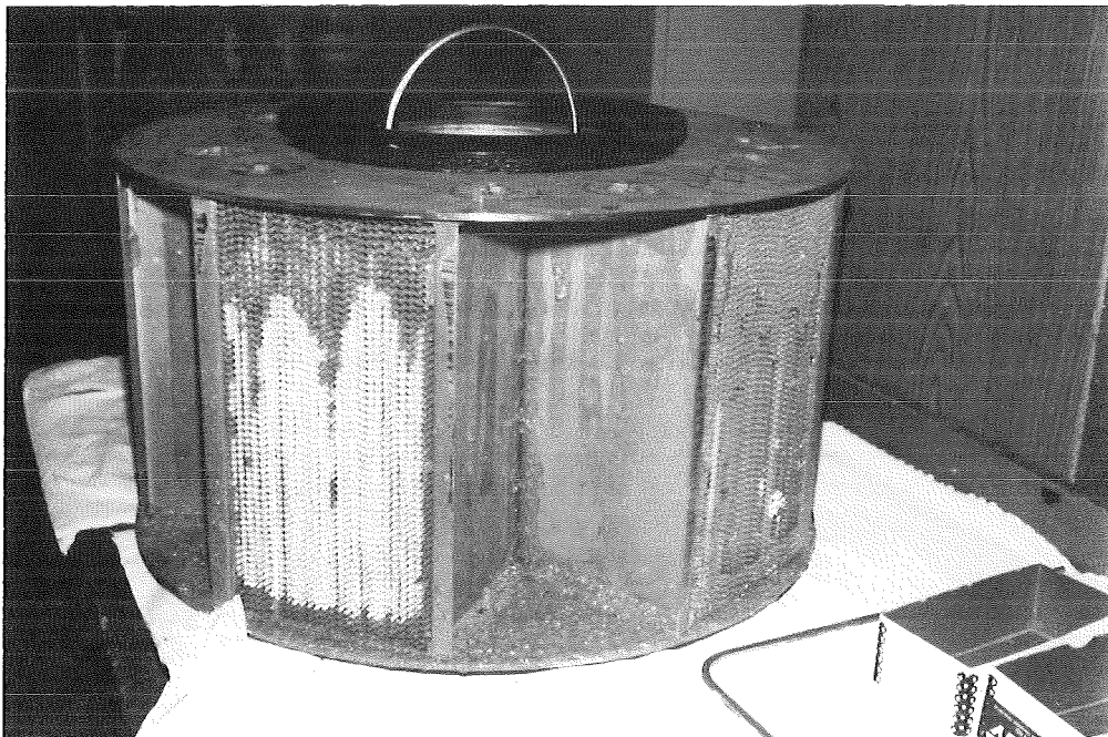
Abb. 8: Schwebstofffilter der Klasse S nach Einwirkung von Abgas mit 5 Vol.-% \text{NO}_2 (alte Bauweise)
