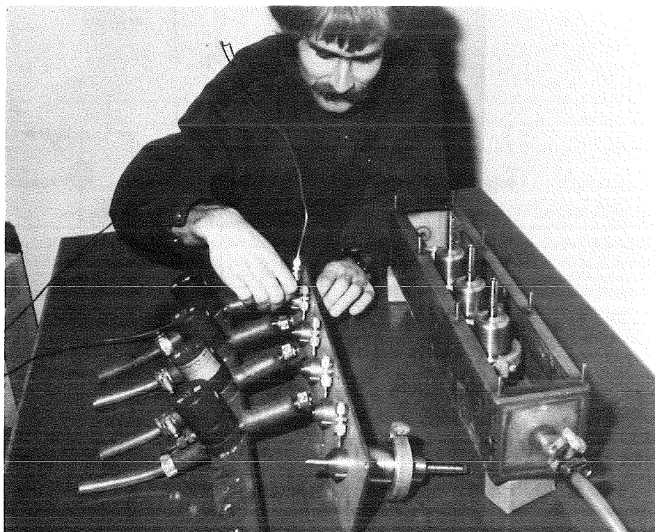
Foto 5.1.1: Filterstation geöffnet. Links Frontplatte mit pneumatisch betätigten Einlassventilen und einem Filtergehäuse. Rechts Box mit weiteren vier Filtergehäusen.
