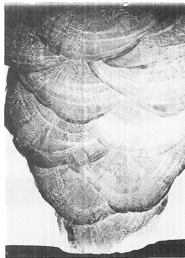
Werkst. Nr. 2.4656, U-Naht Grundwerkstoff Nr.1.4306s Krupp-SW, Ch. 293783, Blech quer Walzrichtung
