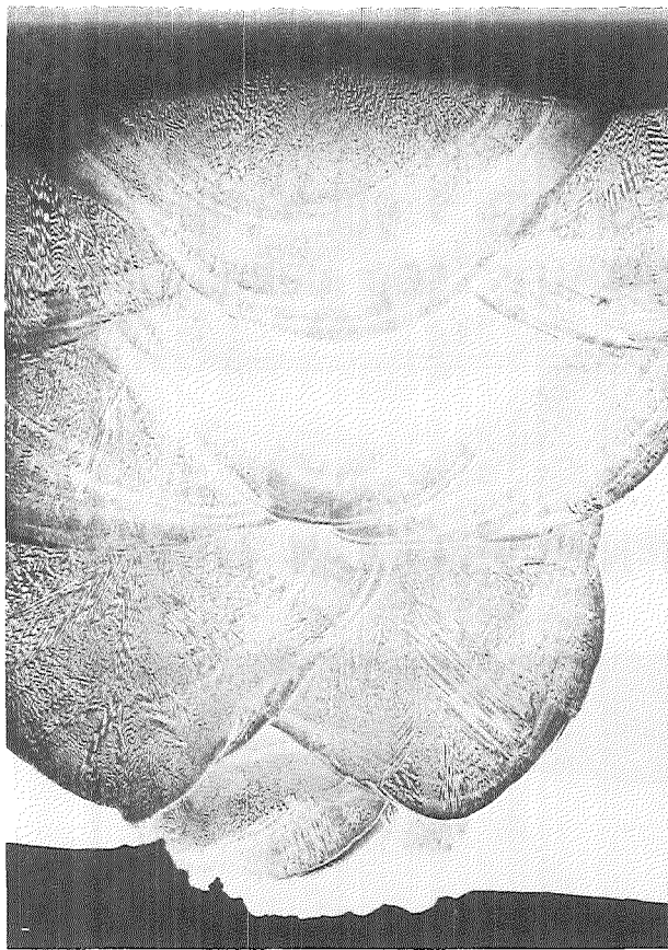
Werkst. Nr. 2.4656, U-Naht Grundwerkstoff Nr.1.4306s Krupp-SW, Ch. 293783 Blech parallel Walzrichtung
