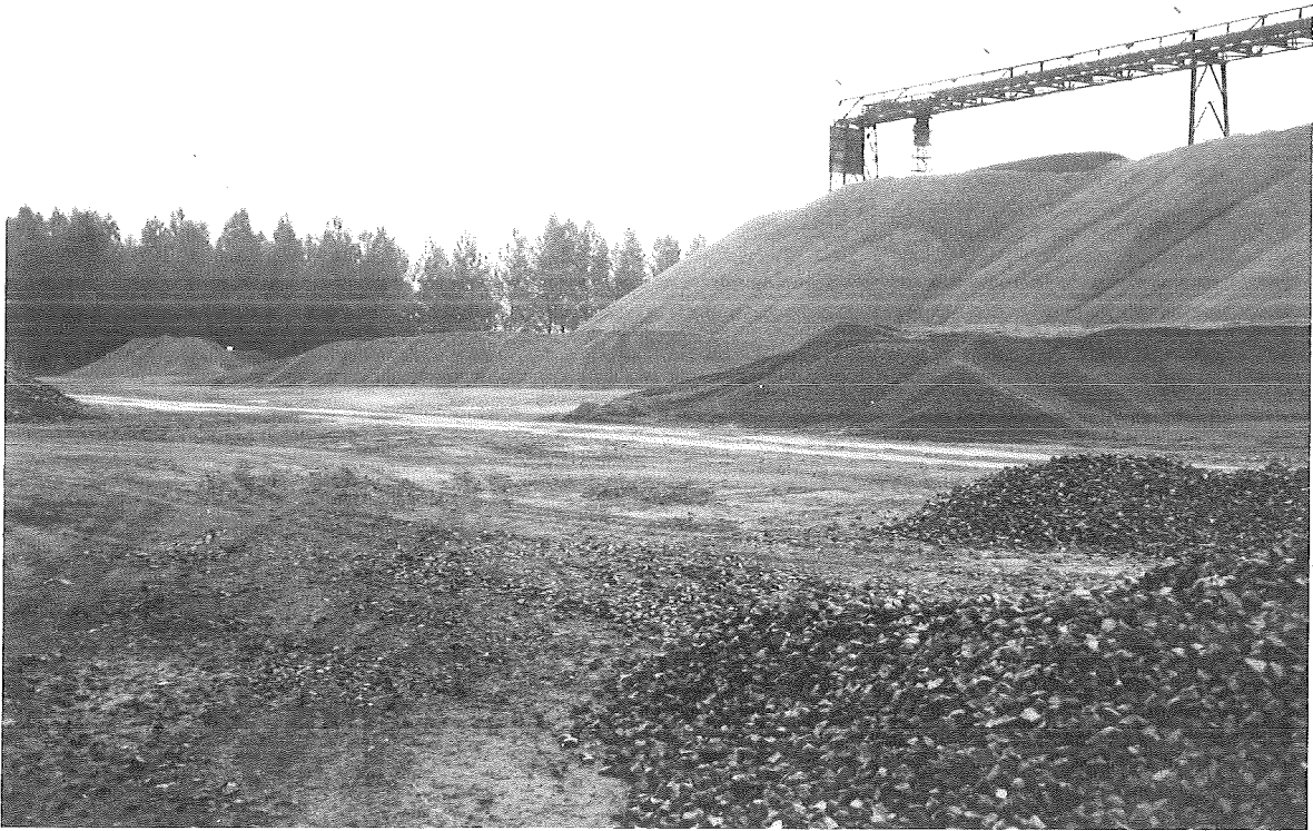
212: Hochofenschlacken, P + S, Werk Salzgitter
