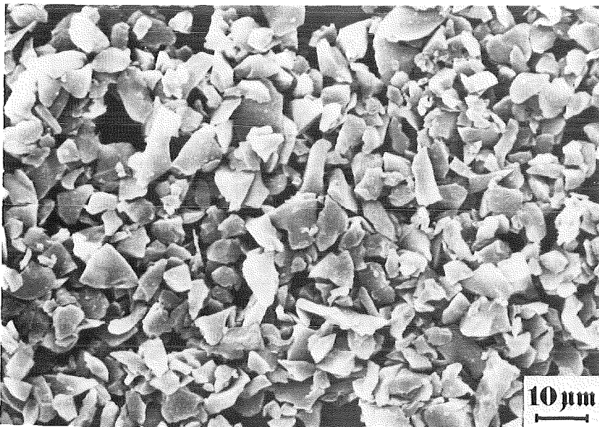
Abb. III/1 Typische Partikel- form des Borcarbid- pulvers (H.C. Starck)
