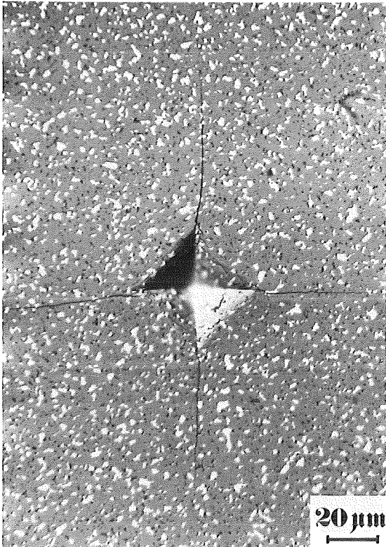
Abb. III/77 Borcarbide + ZrB_2 29.43 N - Vickers- eindruck
