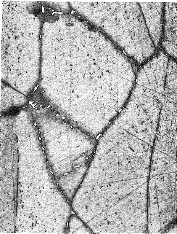
55873 Li.+Bl. 1000:1 Abb. 8: 750 °C; 60 MPa; 201 h; Mikrosegierung mit \sigma -Phase an den Korngrenzen.
