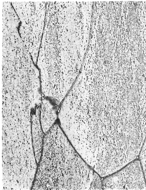
55905 Li.+Bl. 1000:1 Abb. 14: 700 °C; 80 MPa; 407 h; ferritisierte Zonen und Mikro- seigerung an den Korngrenzen.
