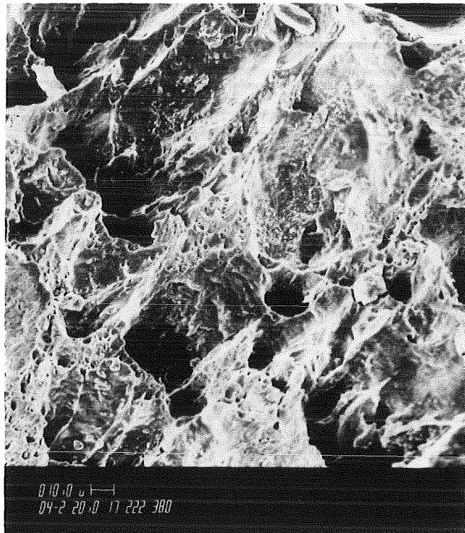
Abb. 57: 700 °C; 140 MPa; 14,5 h; duktiler, transkristalliner Bruch.
