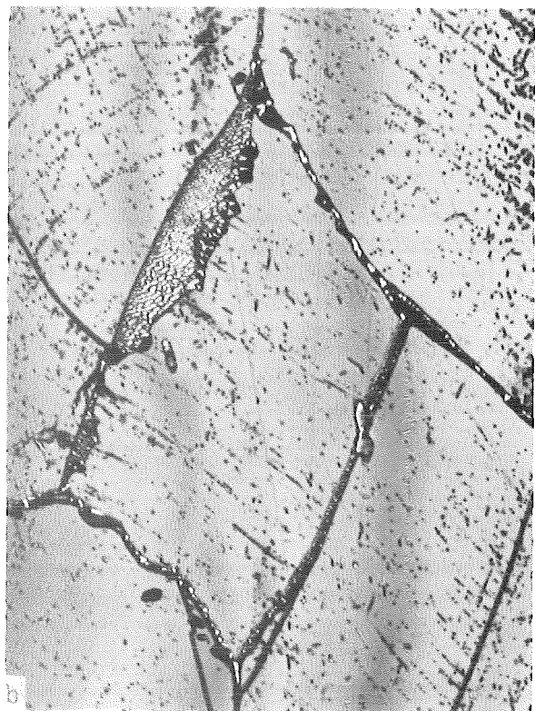
56568 Li.+Bl. 1000:1 56569 Li.+Bl. 1000:1 Abb. 24a u. 24b: 650 °C; 130 MPa; 468 h; Matrixkarbide in Gleitebenen angeordnet.
