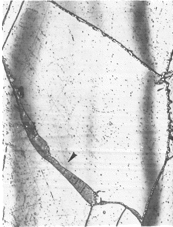
56574 Li.+Bl. 1000:1 Abb. 21: 650 °C; 180 MPa; 29 h; "Stengelkarbide" (Pfeil).
