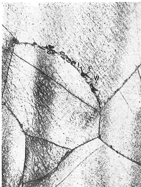
55887 Li.+Bl. 1000:1 Abb. 47: 550 °C; 190 MPa; 7410 h; F = Ferrit (Martensit), W = von gewandelter Korngrenze durchlaufenes Gebiet.
