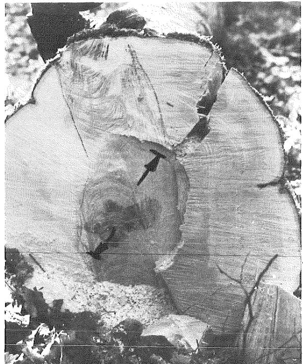
Abb. 24b) Durch die auftretenden Fällrisse werden die inneren Spannungen meist soweit abgebaut, daß keine weiteren Risse entstehen. Die linke Aufnahme zeigt die Stirnfläche vor, die rechte nach Abtrennen der Endscheibe (siehe auch Abb. 24c))
