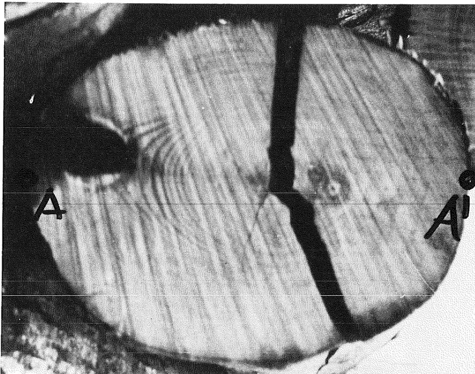
Abb.3 Zusätzliche Biegespannungen bei Präsenz von Zugholz bewirken Bruch längs des kleineren Durchmessers
