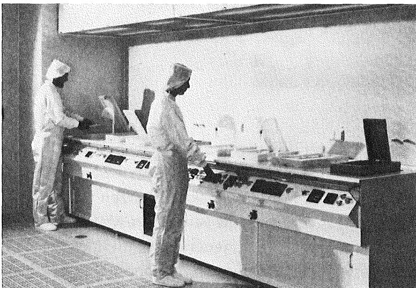
Abb. 35: Arbeitsbereich des Reinraumlabors des IKVT für die Herstellung von Röntgenarbeitsmasken.
