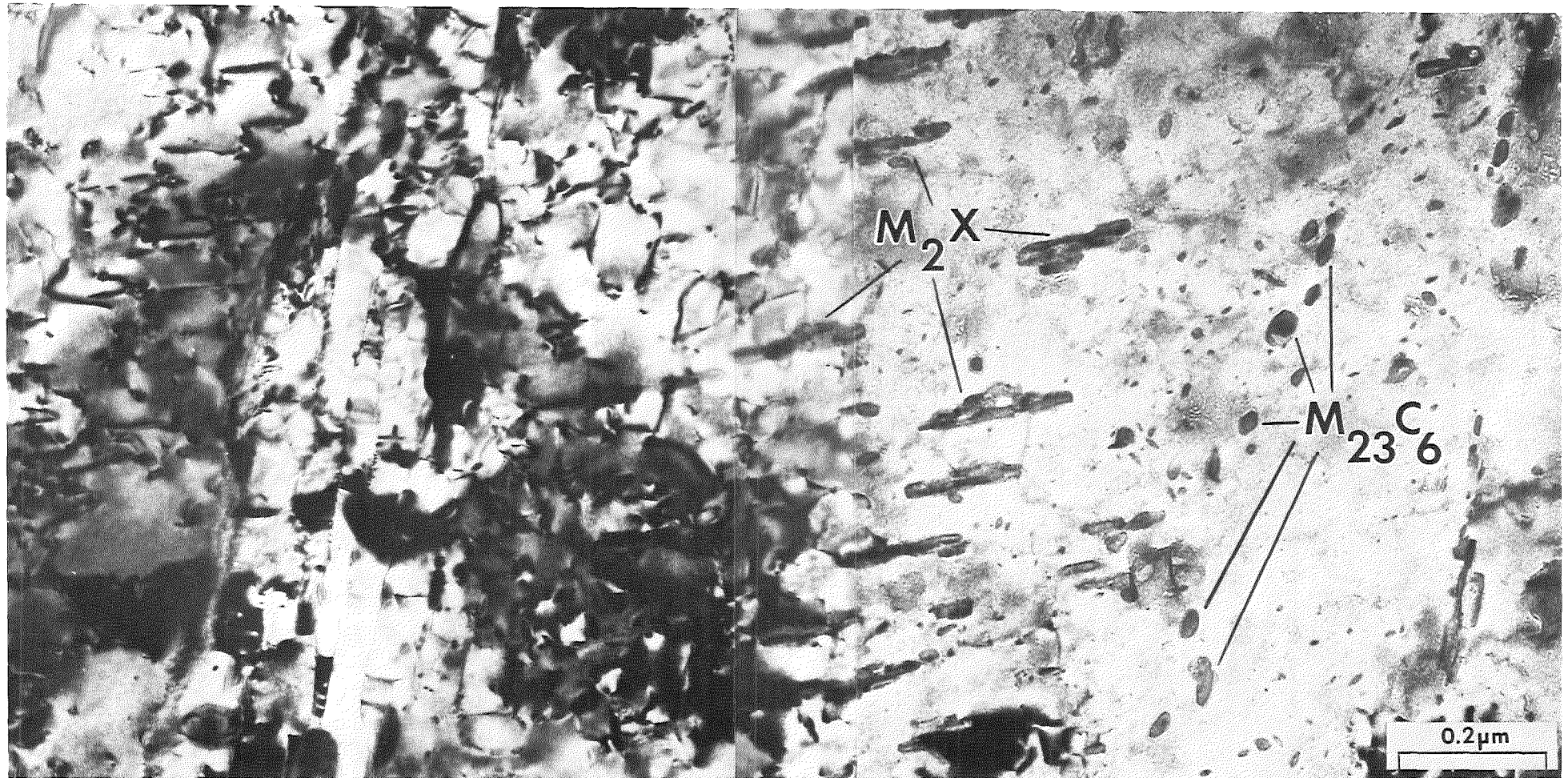
Abb.23: Auflösung von M_2X und Entstehung von M_{23}C_6 nach 1075^\circ C 30 min/Luft + 600^\circ C 2h/Luft.
