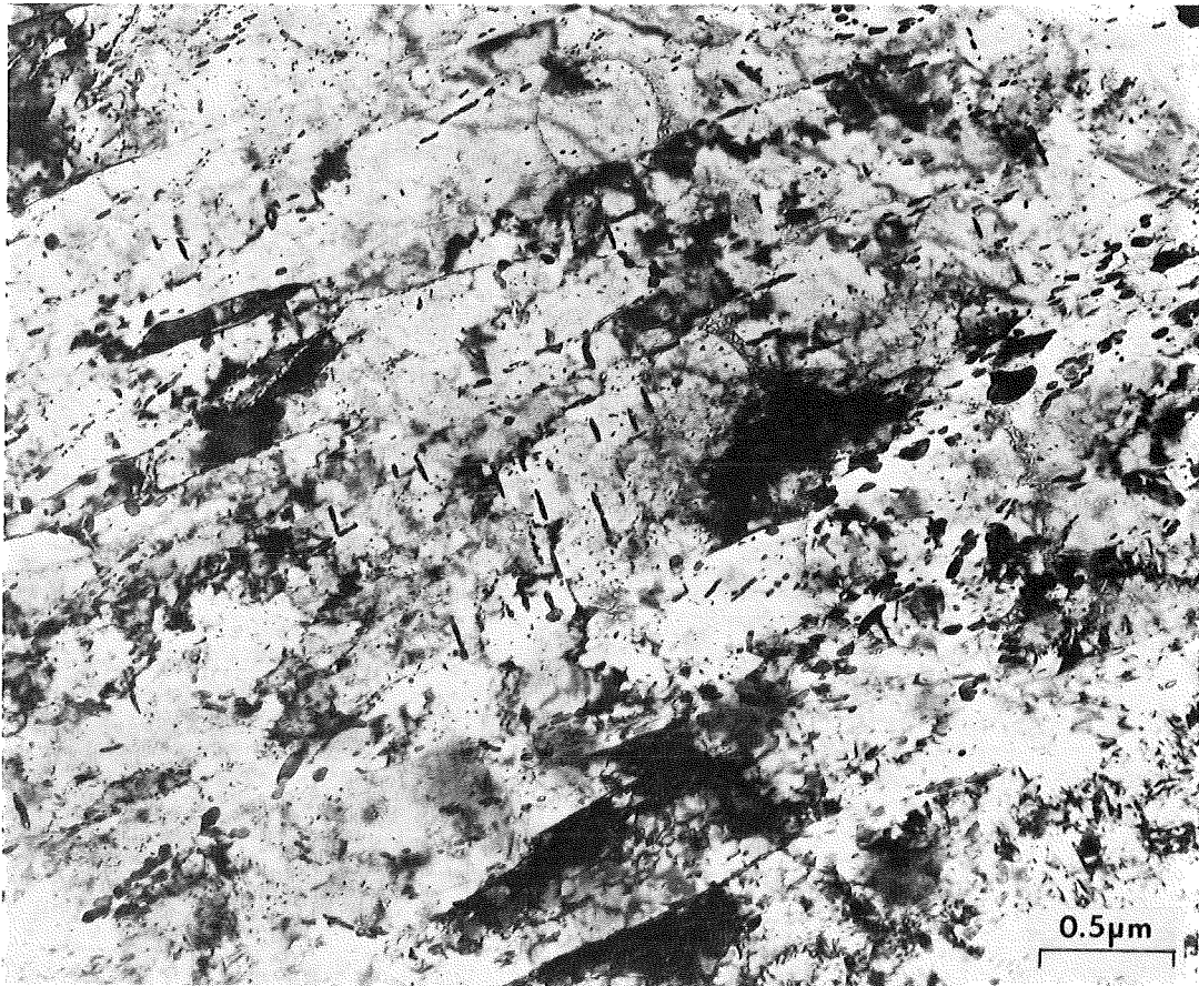
Abb.22: das Mikrogefüge im TEM nach 1075^{\circ}\text{C} 30 min/Luft + 600^{\circ}\text{C} 2h/luft.
