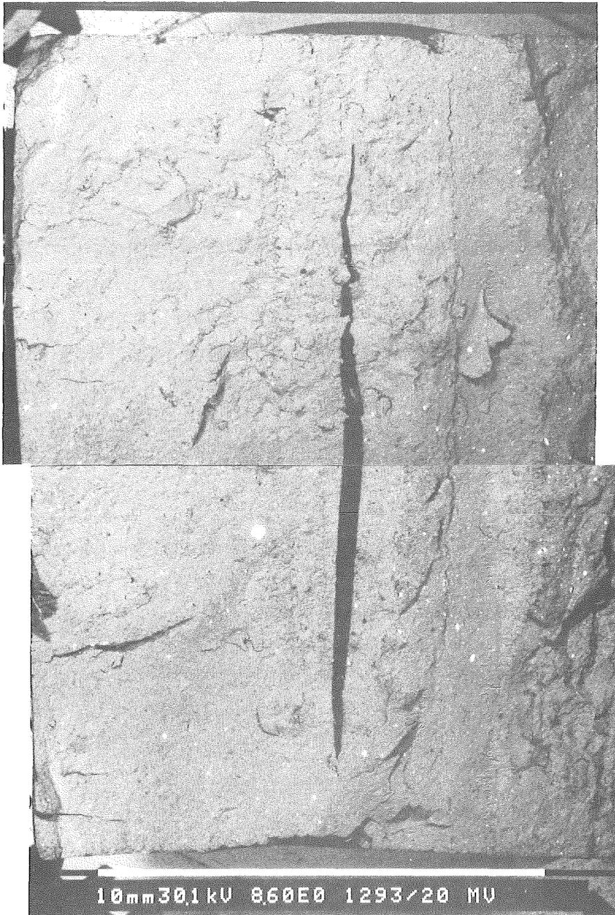
Abb. Probe Nr. 1: Ribbildung am gesinterten Keramik-Pellet
