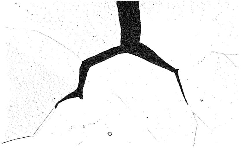
Abb. 60: KRW,  $T = 550^{\circ}\text{C}$ : verzweigte Rispitzen, 500fache Vergrerung von Versuch CT10 (siehe auch Abb. 59)
