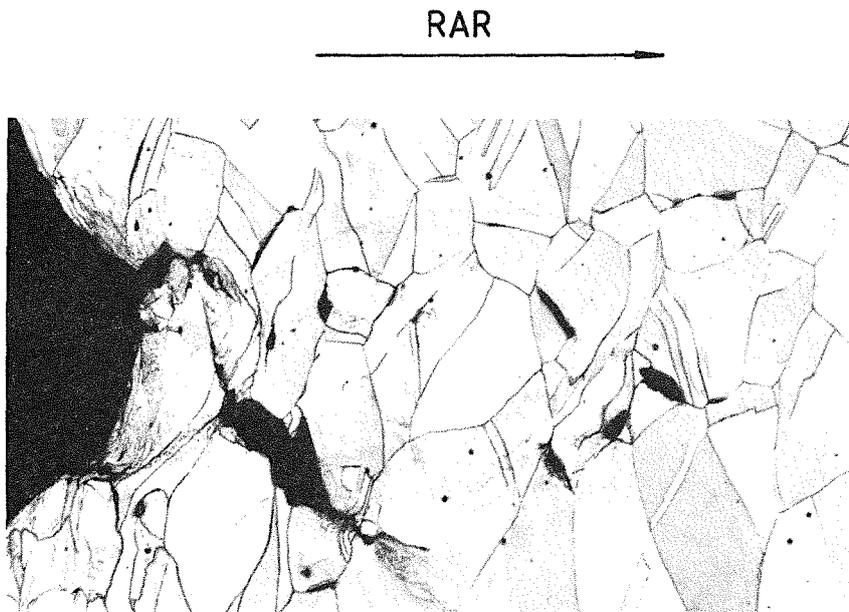
Abb. 65: CCPN11, Mikrostruktur des Kriechrißbereichs, 100fache Vergrößerung
